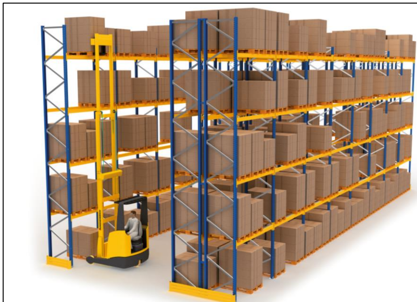
Slika 19. Prikaz visokoregalnog paletnog skladišta jednostruke dubine
