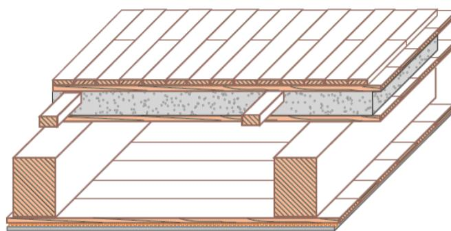
(slojevi, odozdo prema gore: žbuka, trstika, daske, grede/zrak, daske, letve/šuta, daske, podna obloga)
