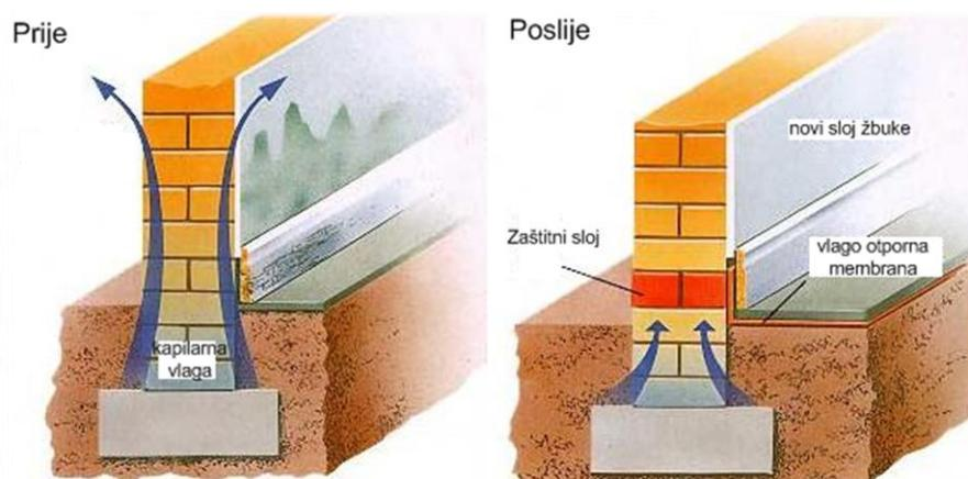
Slika 3.23 Primjer sanacije zida od kapilarne vlage
