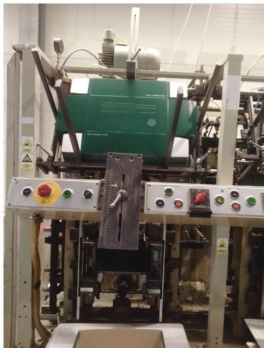
Slika 7. Stroj za izradu kutija
