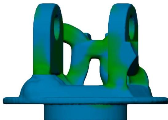
Slika 82 – Prikaz modela prihvata palca nastalog postupkom generativnog dizajna s prikazanim naprezanjima
