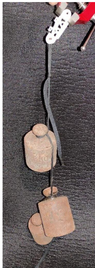
Slika 100 - Opterećenje od 50 N pod kutom  $45^\circ$  na smjer slaganja slojeva
