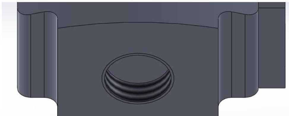
Slika 35 – Dio za pričvršćivanje šake na ostatak ruke ili za korištenje šake kao end effector-a
