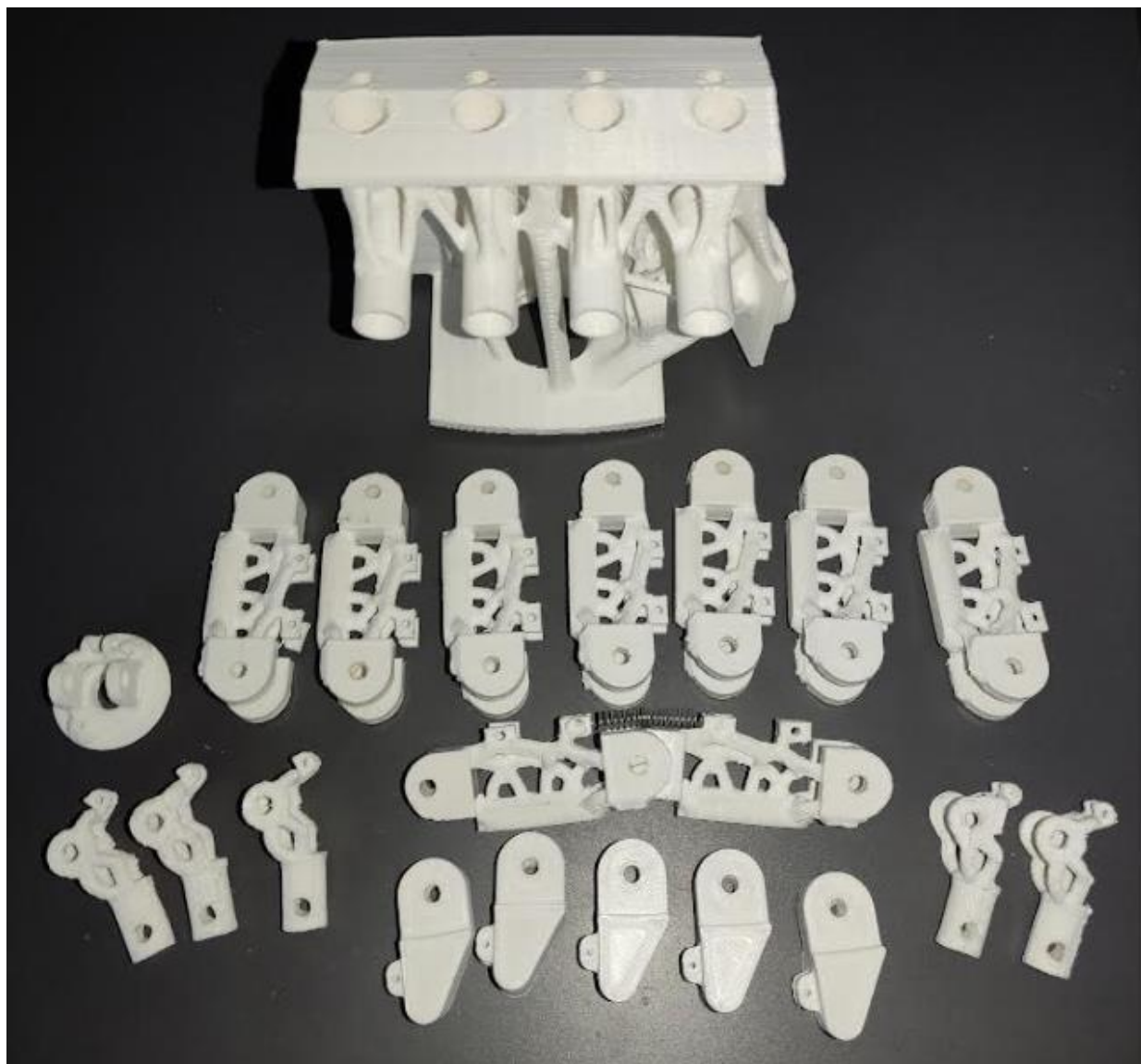
Slika 92 – Izrađeni dijelovi funkcionalnog prototipnog modela
