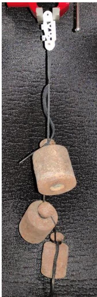
Slika 98 – Opterećenje od 50 N u smjeru slaganja slojeva
