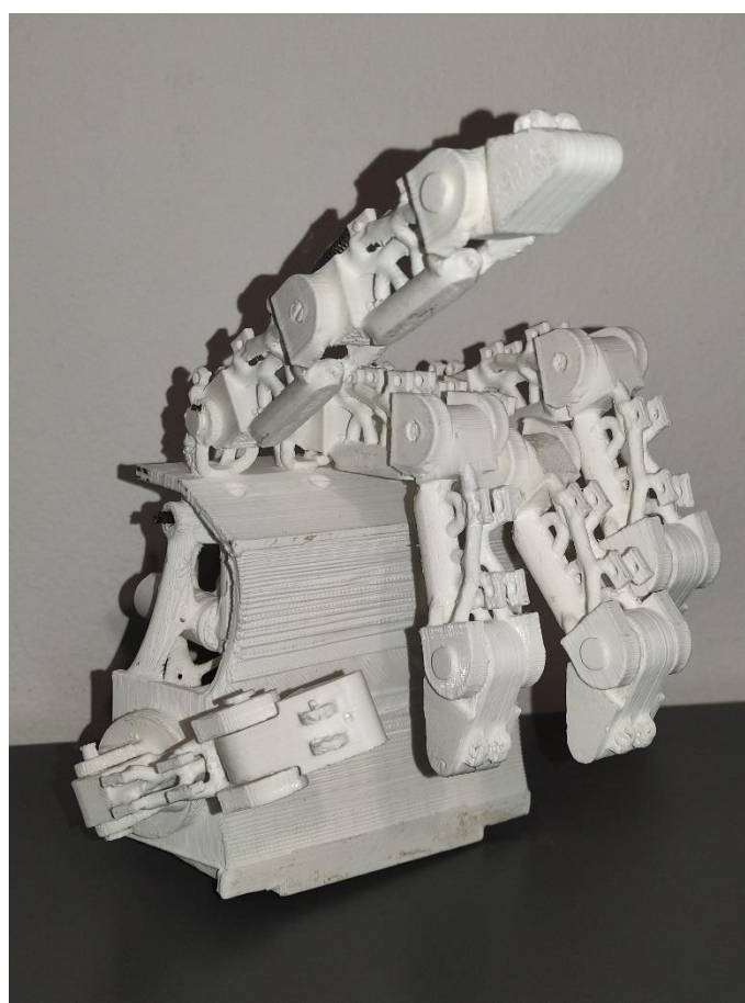
Slika 103 – Gotov prvi, funkcionalni, prototipni model bioničke šake
