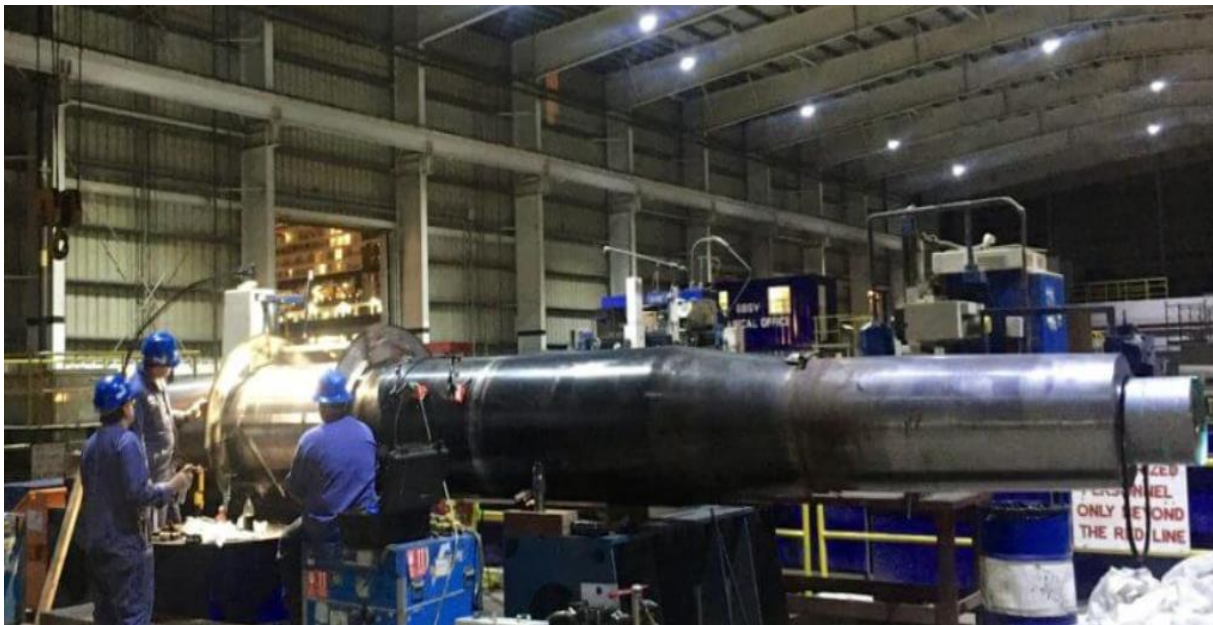
Slika 4.5 Tokarenje osovine broda za krstarenje s prijenosnim tokarskim strojem u radionici [24]
