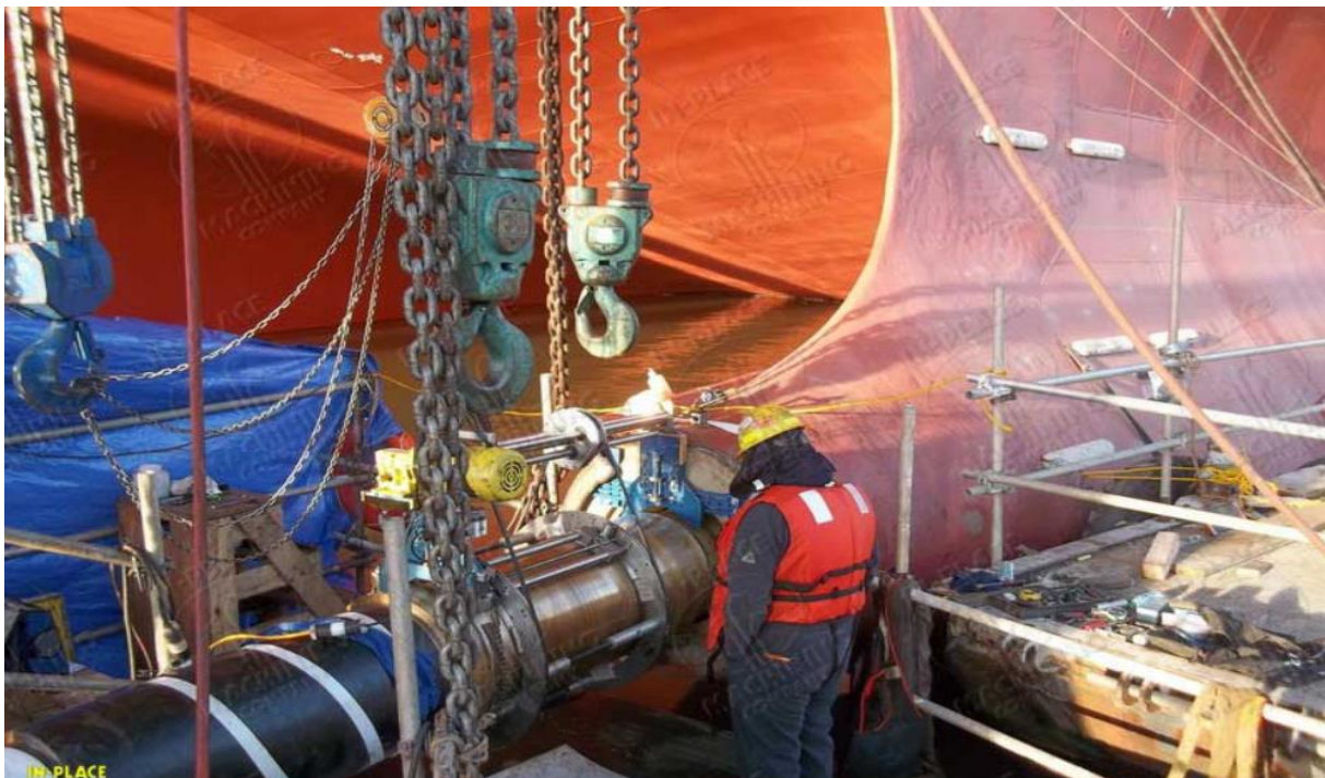
Slika 4.6 Tokarenje pogonske osovine broda s prijenosnim tokarskim strojem na terenu [24]
