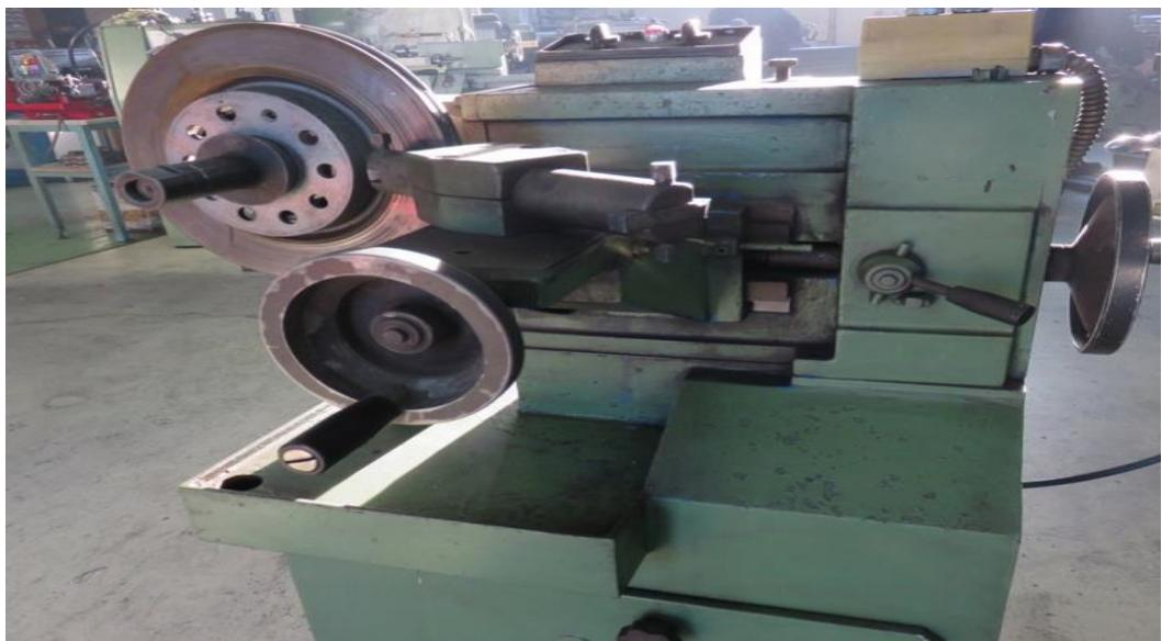
Slika 4.10 Tokarenje kočionog diska na normalnom stroju
