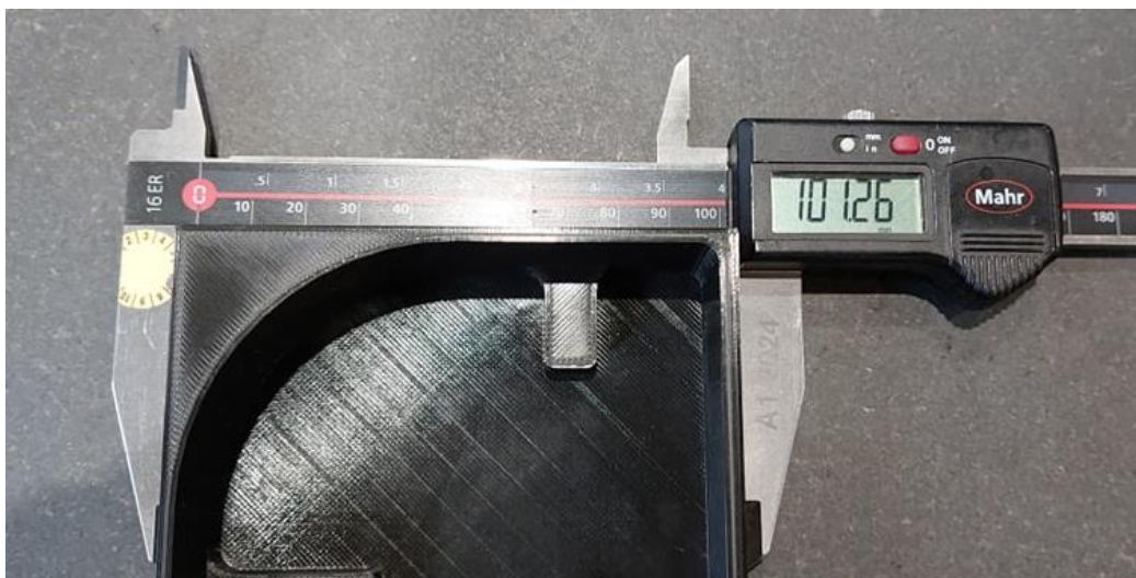
Slika 5.2 Mjerenje vanjske dimenzije; nazivna mjera 101 mm [izvor: rad autora]
