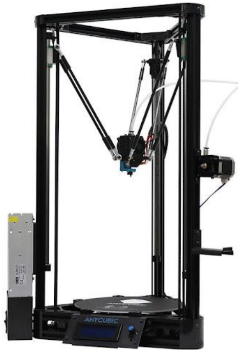
Slika 2.15 Delta izvedba FDM 3D printera[17]
