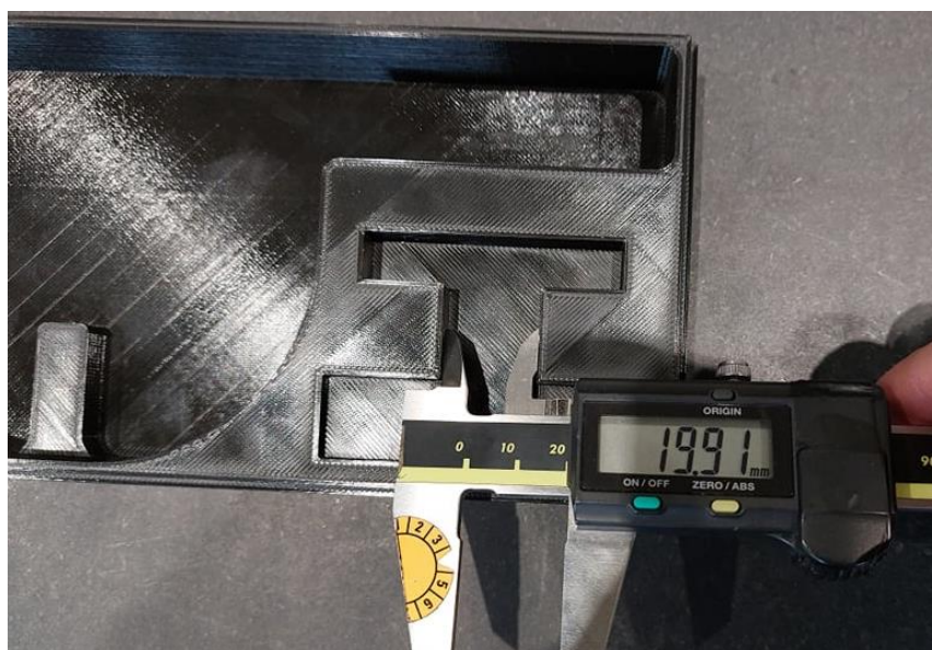
Slika 5.4 Mjerenje unutarnje dimenzije; nazivna mjera 20 mm [izvor: rad autora]
