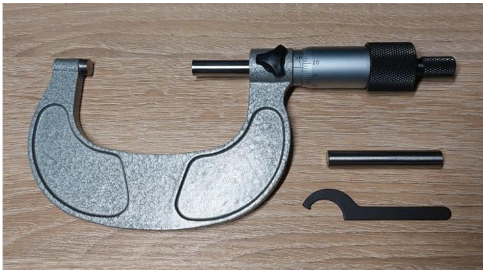
Slika 4.1 Mikrometar, mjerni etalon, ključ za kalibraciju[izvor: rad autora]
