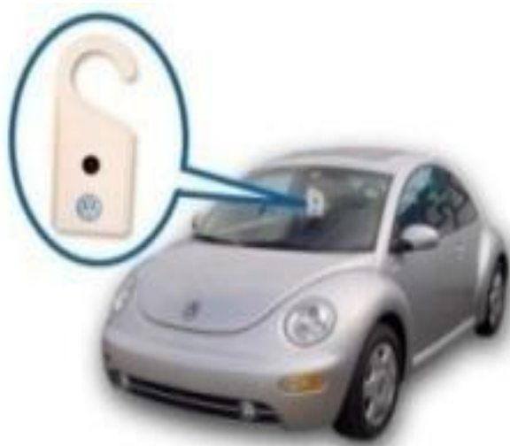
Slika 4. Primjer mogućeg označavanja vozila RFID oznakama
