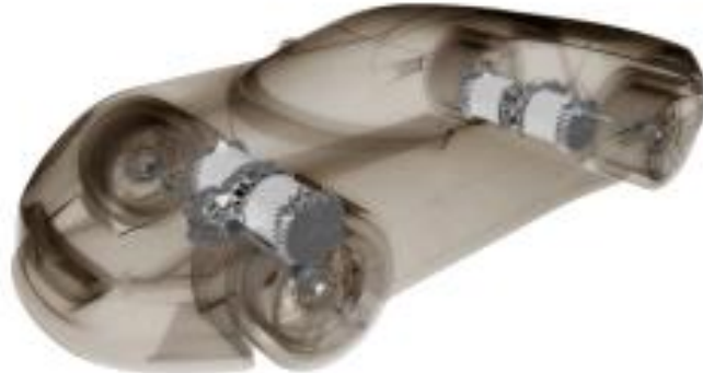
Slika 3.8. Diferencijal i elektromotor u sklopu ovjesa kotača, Concept One, Rimac automobili
