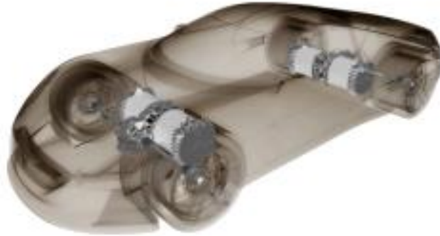
Slika 3.8. Diferencijal i elektromotor u sklopu ovjesa kotača, Concept One, Rimac automobili
