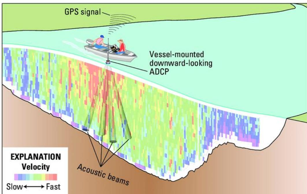
Slika 4.3. Ilustracija mjerjenja protoka pomoću ADCP uređaja pričvršćenog za plovilo [15]
