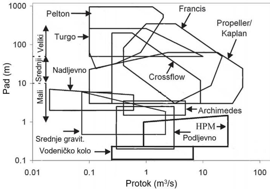
Slika 3.7. Radni dijagram turbina. Vodenička kola i HPM istaknuti su debljim linijama jer se o njima raspravljalio u ovom radu ( prilagođeno iz [10])
