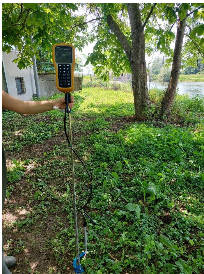
Slika 4.9. Uređaj FlowTracker2 spreman za rad
