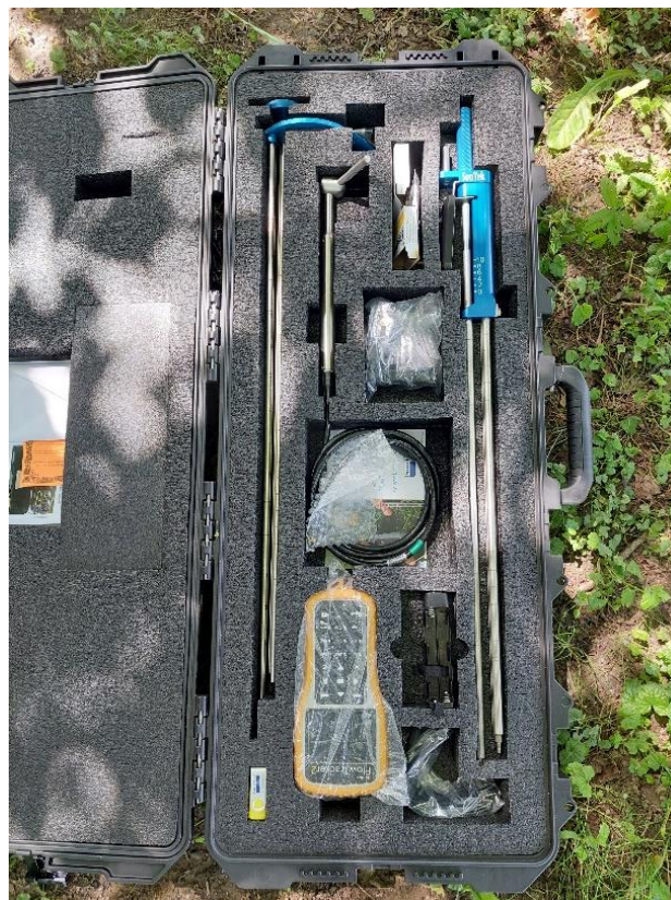
Slika 4.6. Dijelovi mjernog uređaja FlowTracker2
