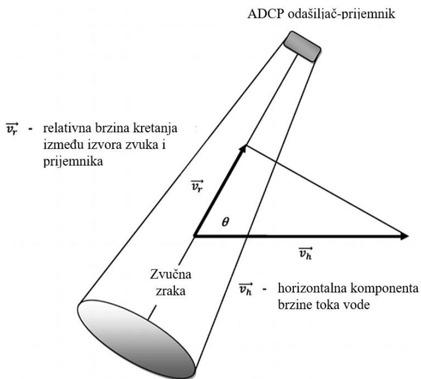
Slika 4.1. Mjerenje protoka pomoću ADCP metode [13]
