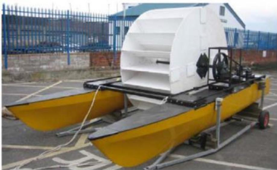
Slika 3.4. Vodenica za proizvodnju električne energije [9]
