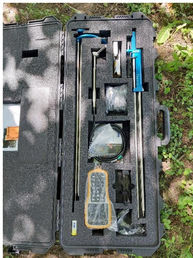
Slika 4.6. Dijelovi mjernog uređaja FlowTracker2
