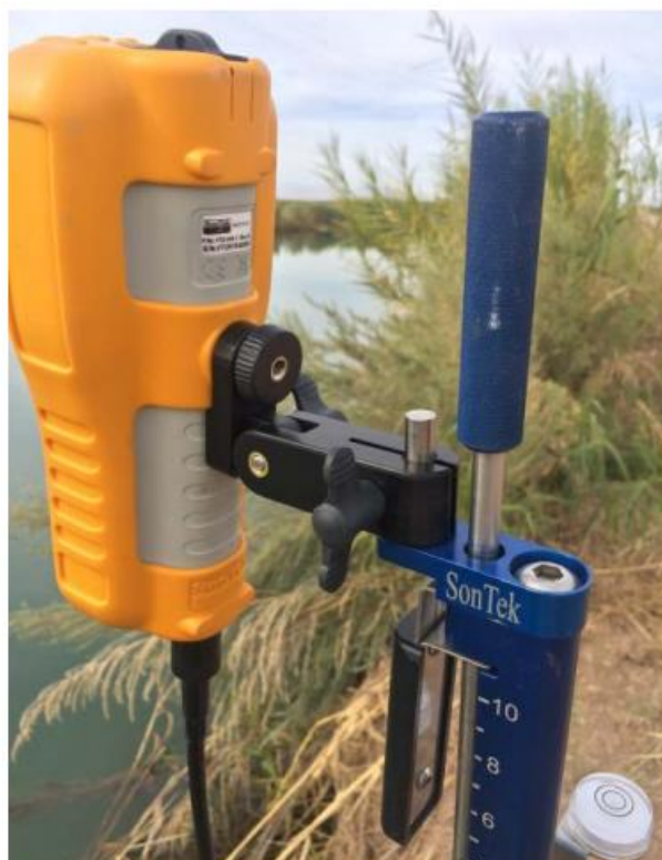
Slika 4.8. Nosač za montažu – spajanje ručnog uređaja na vrh gornje šipke za podešavanje [19]
