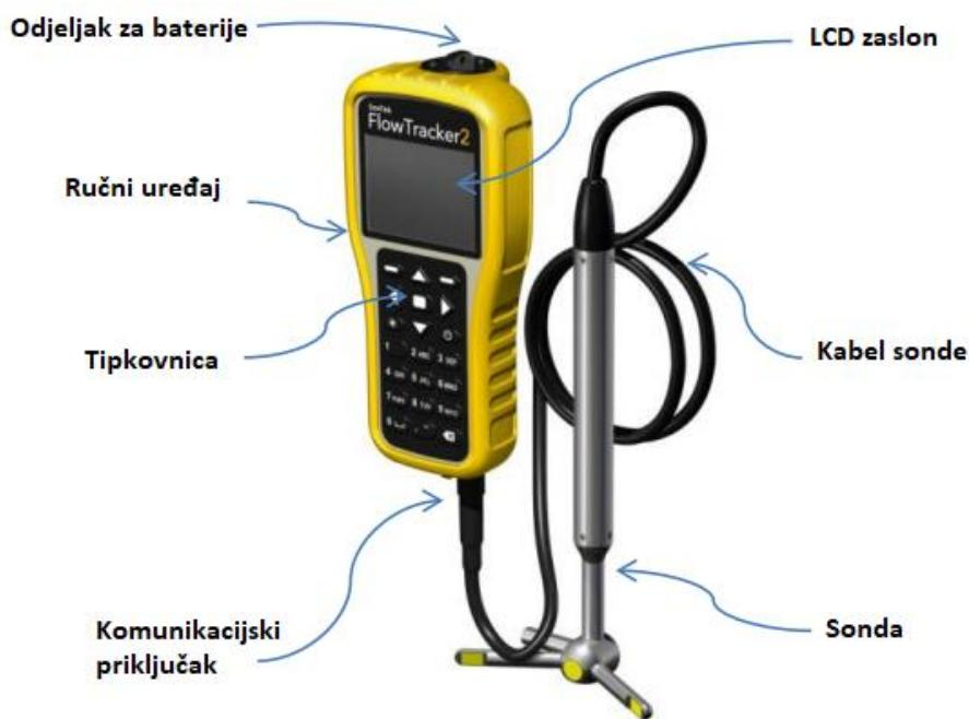
Slika 4.7. Dijelovi instrumenta [19]
