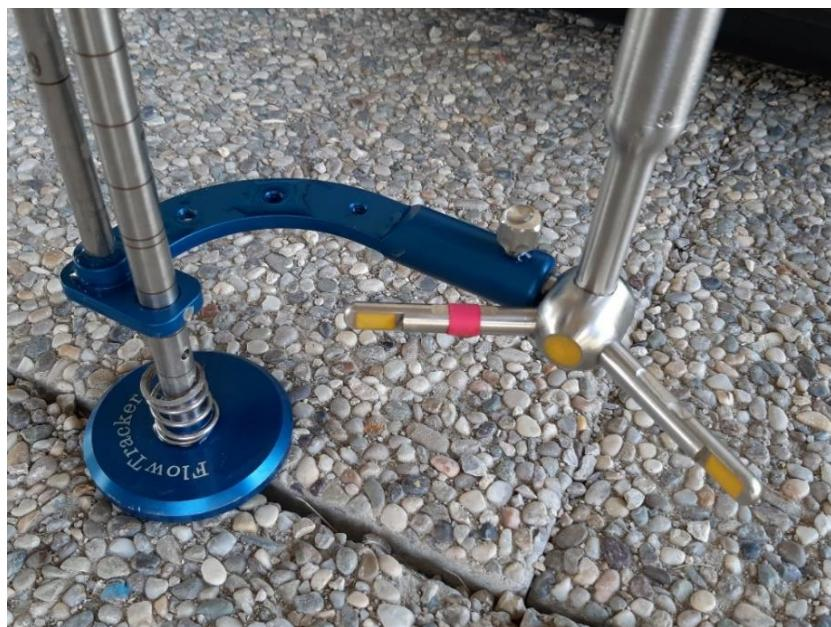
Slika 4.5. 2D sonda korištena prilikom hidroloških mjerena
