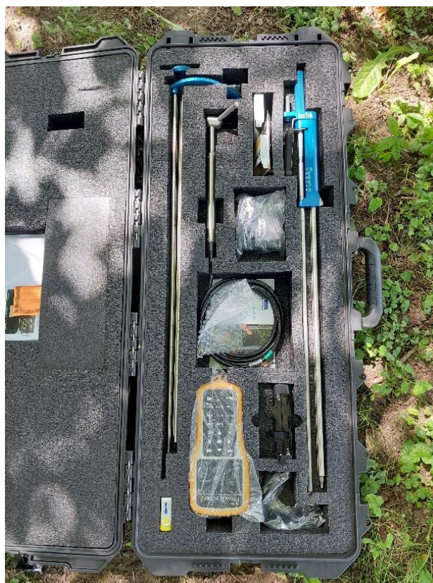
Slika 4.6. Dijelovi mjernog uređaja FlowTracker2
