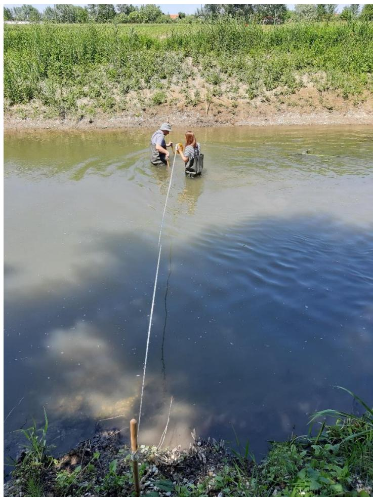
Slika 4.19. Postavljanje mjerene trake na mjerenoj lokaciji u Luki Ludbreškoj
