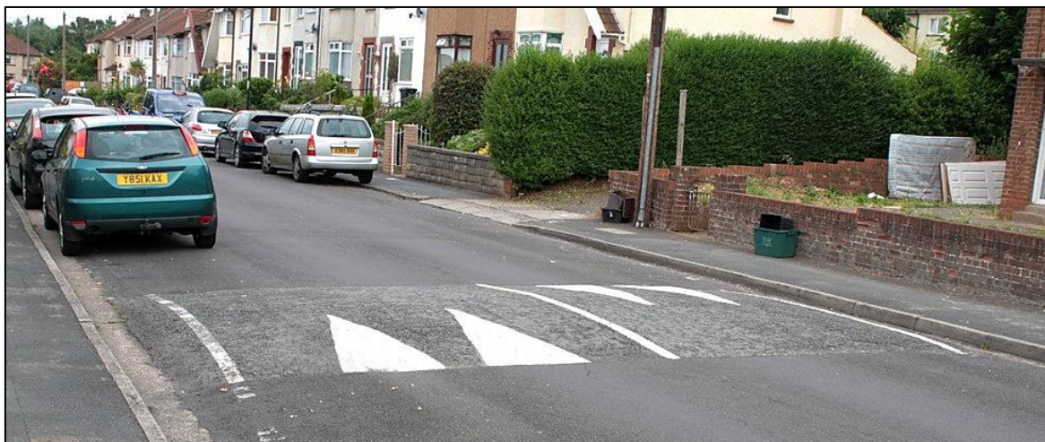
Slika 5.14. Tip cestovnog uspornika prometa
