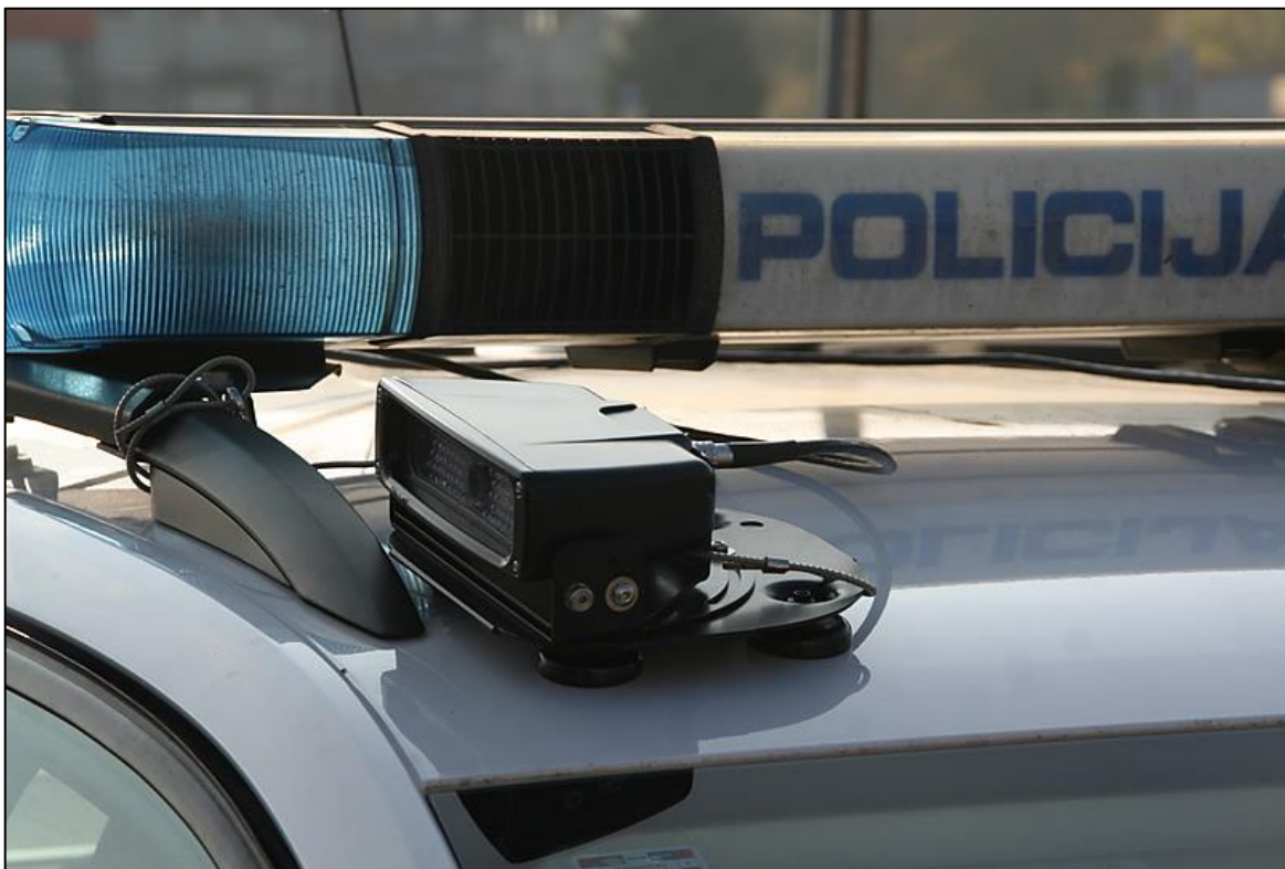
Slika 5.10. ANPR sustav na policijskom vozilu
