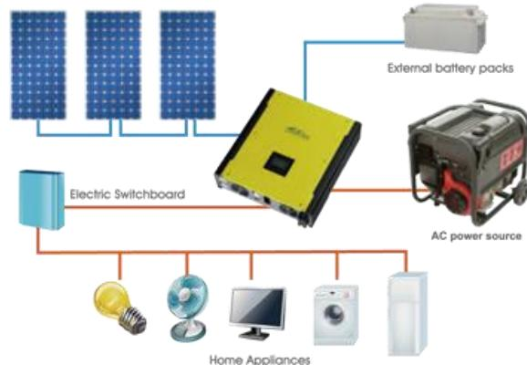
Slika 6. Hibridni solarni sustavi. Izvor: [5]
