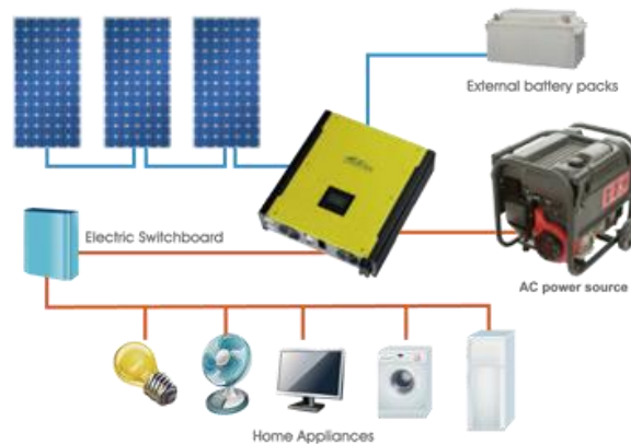
Slika 6. Hibridni solarni sustavi. Izvor: [5]
