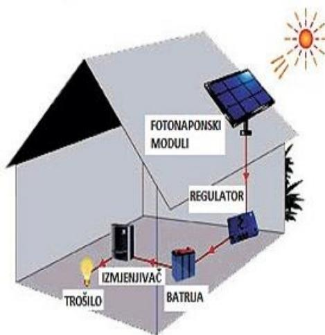
Slika 5. Otočni ili samostalni fotonaponski sustavi. Izvor: [5]
