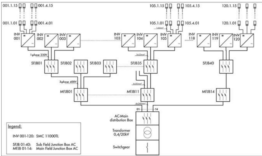
Slika 13. Blok dijagram PV postrojenja od 1,2 MW s višestrukim izmjenjivačima SMC 11 000
