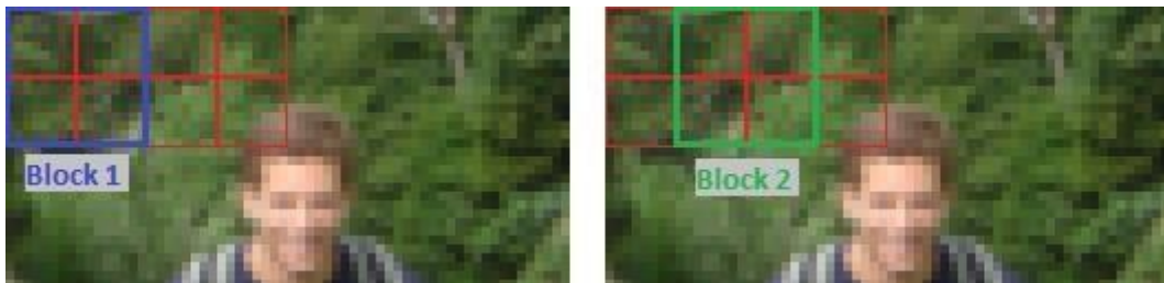
Slika 2.7. Pomicanje normalizacijskog bloka ćelija (izvor: http://mccormickml.com/2013/05/09/hog-person-detector-tutorial/ )
