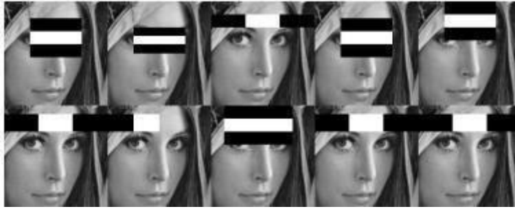
Slika 2.2. Prikaz Haarovih značajki na ljudskom licu (izvor: https://zir.nsk.hr/islandora/object/algebra%3A252 )
