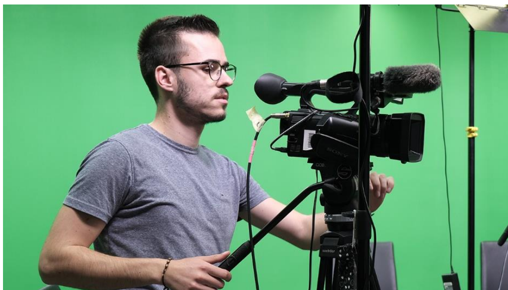
Slika 4.1. – Sony PXW-Z150 kamera s priključenim SDI kablom
