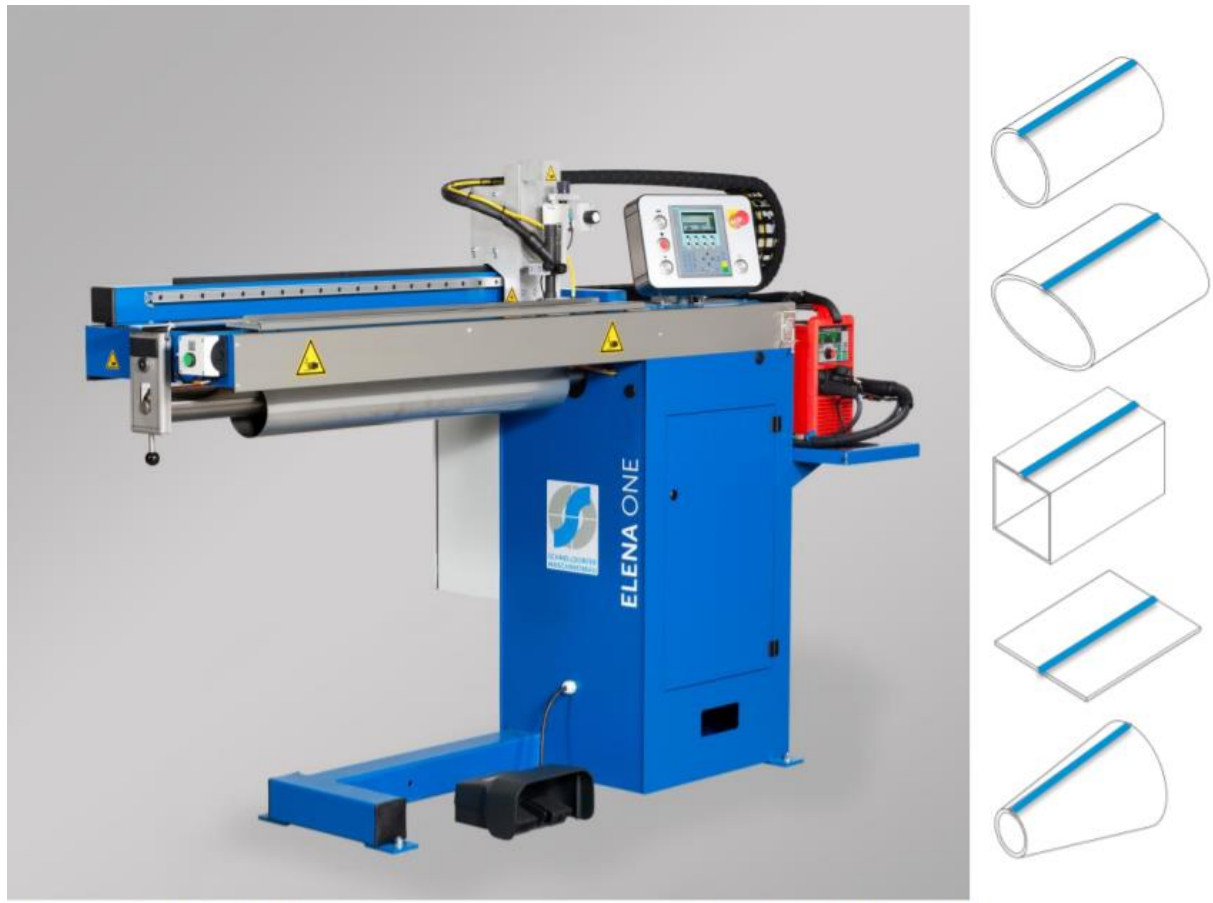
Slika 25. Prikaz Semac Elena One automata i primjera mogućih zavarivanja cijevi
