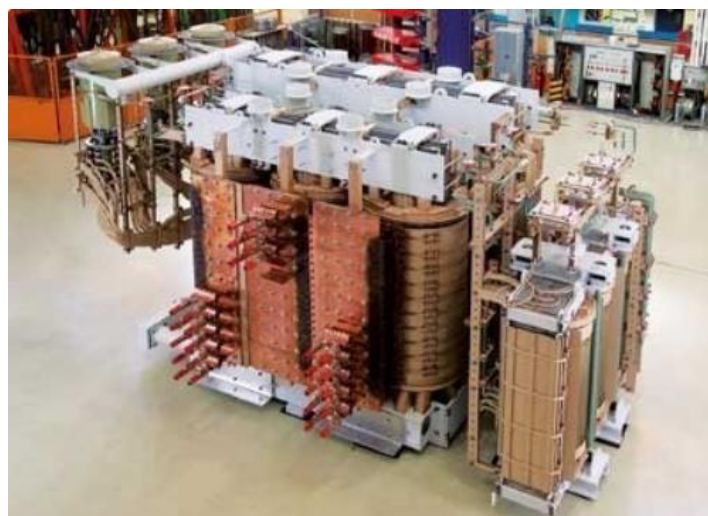
Slika 5. Korištenje bakra kod namotaja transformatora
