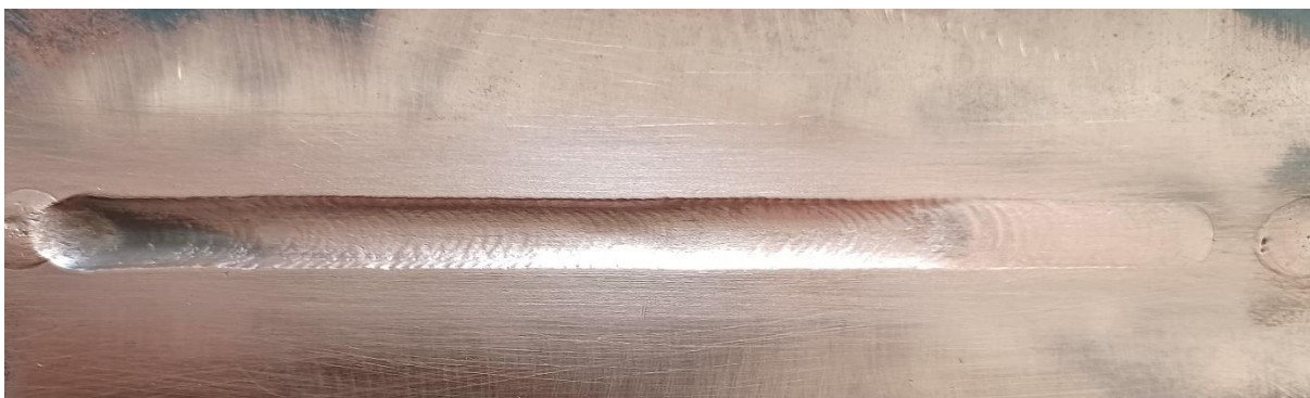
Slika 48. Lice zavara petog uzorka
