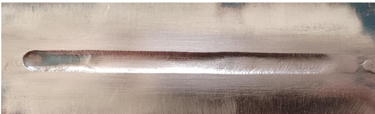
Slika 49. Lice zavara šestog uzorka
