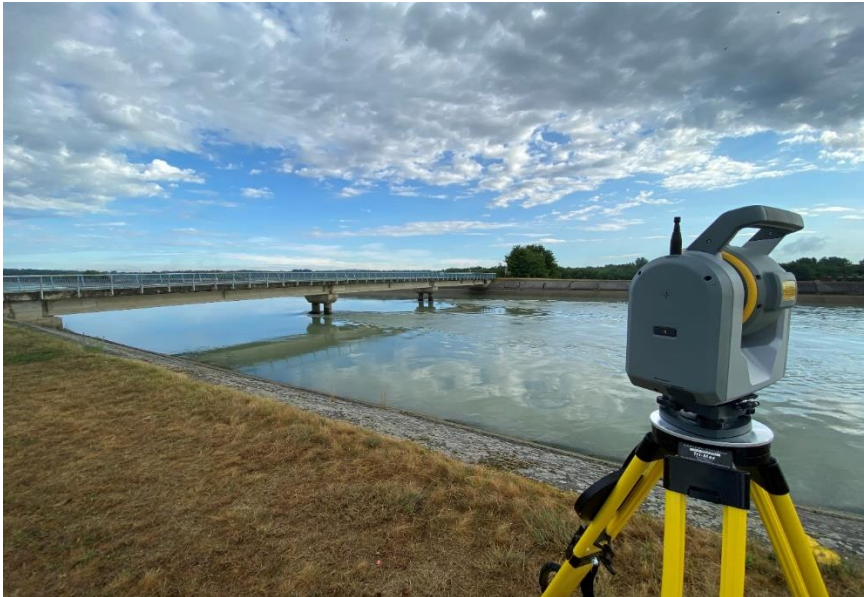
Slika 11. 3D Skeniranje mosta „Družbinec“ [19]
