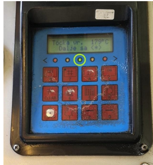
Slika 27. Vrlo dobra kočna tekućina, treperi zelena dioda (fotografirano 10.06.2021.)
