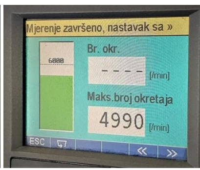
Slika 8. Maksimalni broj okretaja motora (fotografirano 17.06.2021.)
