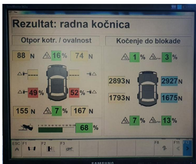
Slika 44. Rezultati ispitivanja radne kočnice (fotografirano 17.06.2021.)
