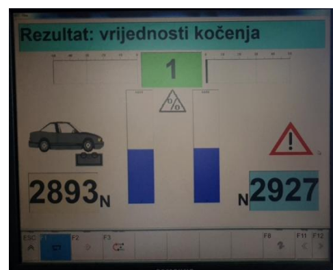
Slika 40b. Kočne sile na prednjoj osovini (fotografirano 17.06.2021.)
