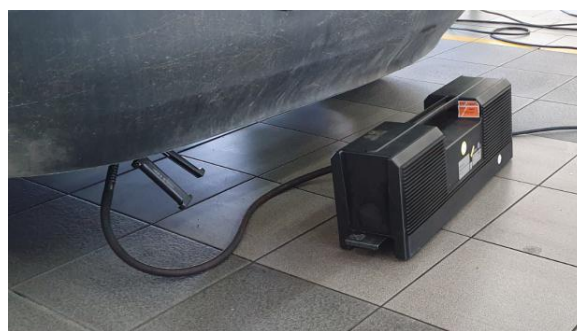
Slika 10. Mjerna sonda postavljena u ispušnu cijev (fotografirano 17.06.2021.)
