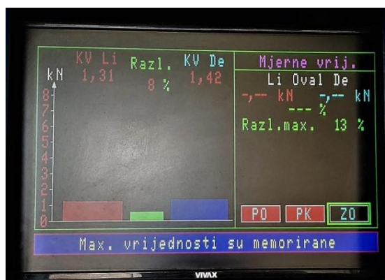
Slika 42a. Kočne sile pomoćne kočnice (fotografirano 10.06.2021.)
