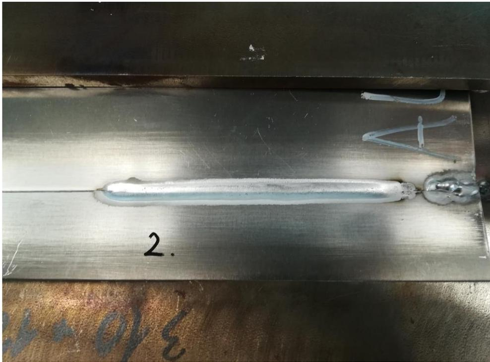
*Slika 4.6. Lice zavara drugog uzorka*
