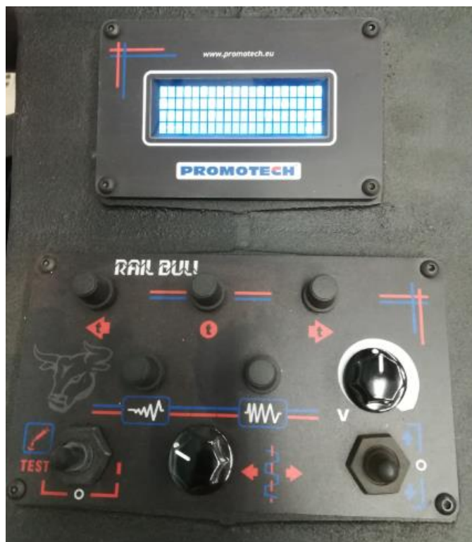
Slika 4.2. Ekran automata Rail Bull
