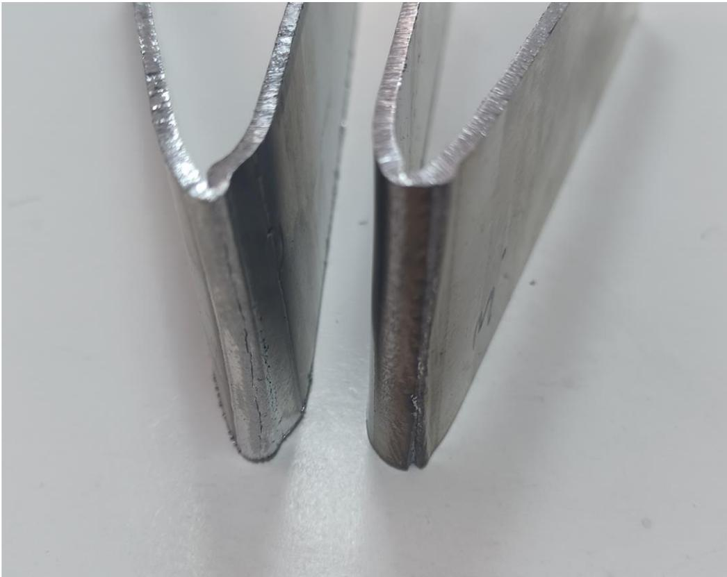
*Slika 4.14. Prikaz rezultata ispitivanja savijanjem lica i korijena epruvete 3.*
