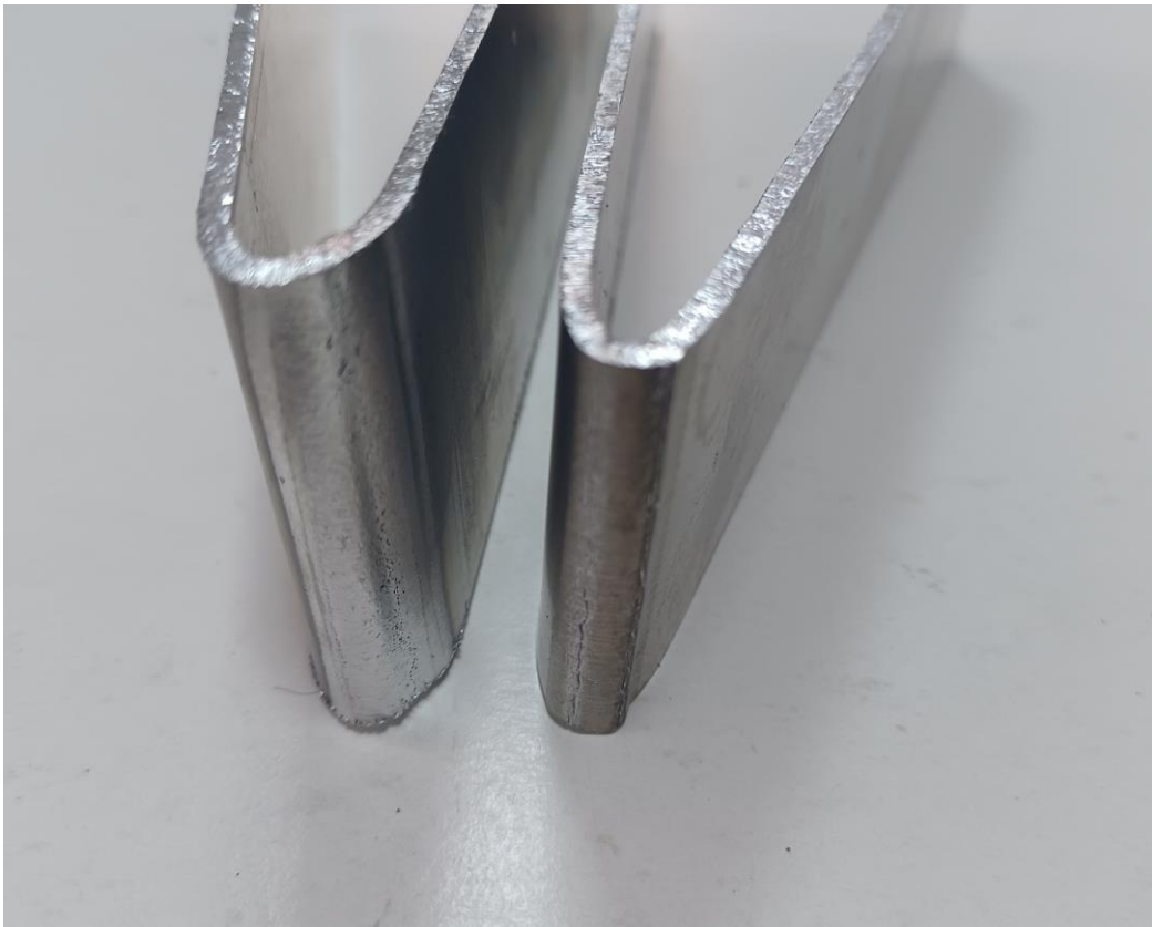
Slika 4.13. Prikaz rezultata ispitivanja savijanjem lica i korijena epruvete 2.
