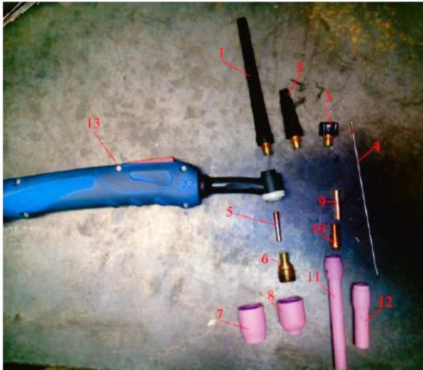
Slika 3.14. Najčešći dijelovi pištolja za TIG postupak zavarivanja [18]
