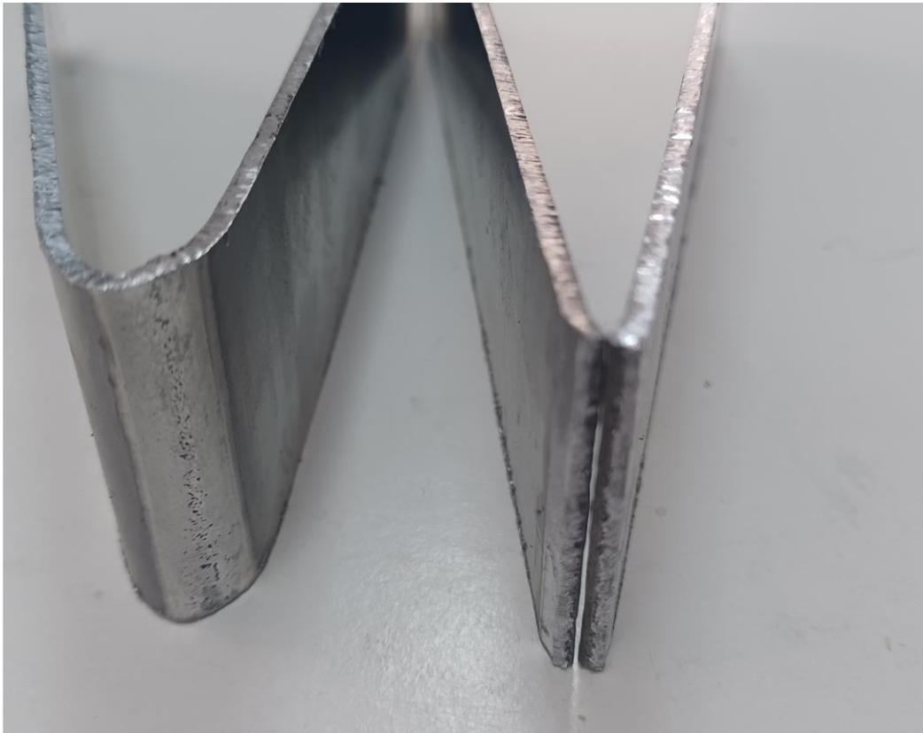
*Slika 4.12. Prikaz rezultata ispitivanja savijanjem lica i korijena epruvete 1.*
