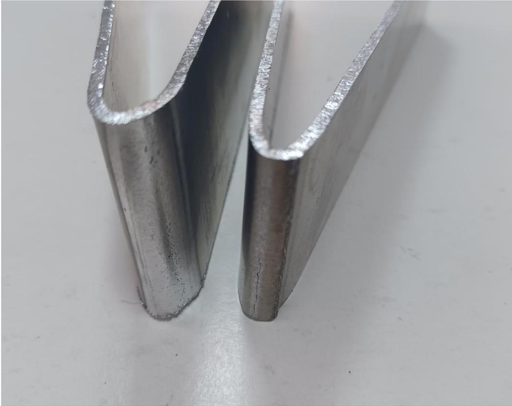
*Slika 4.13. Prikaz rezultata ispitivanja savijanjem lica i korijena epruvete 2.*
