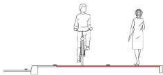
Slika 3.32 Primjer biciklističko – pješačke staze sa jednosmjernim kretanjem biciklista i pješaka [9]
