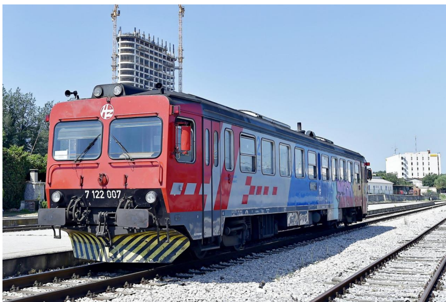
Slika 8. Primjer HŽ-ovog putničkog vlaka, DMV serije 7 122 – "Šved"
