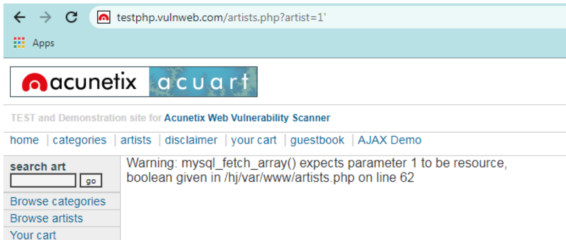
Slika 3.5 Greška web aplikacije nakon unesene zlonamjerne vrijednosti
