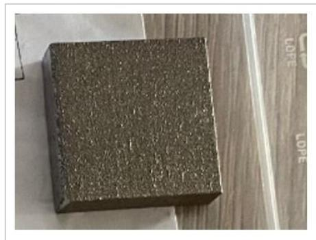
Slika 23. Uzorak MARAGING čelika dobivenog SLM postupkom.
