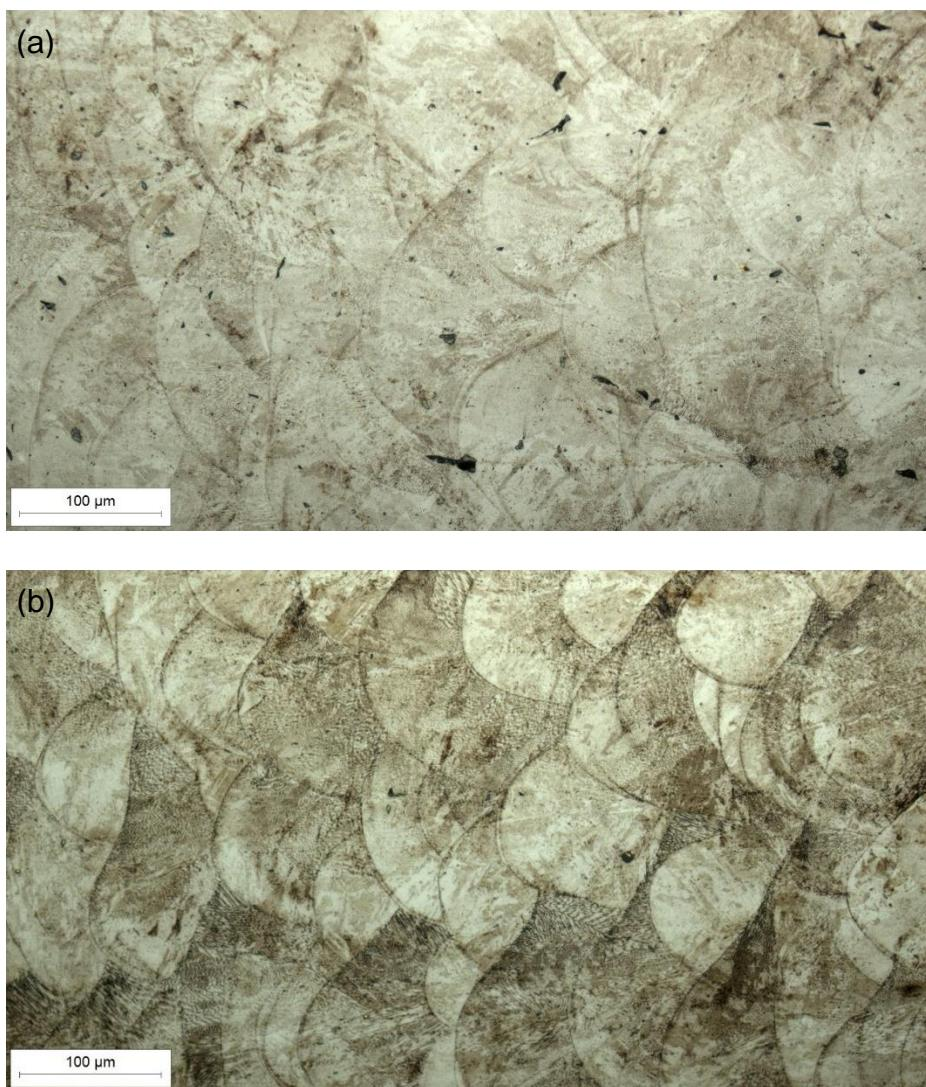
Slika 32. Povećanje 200 x. (a) Poprečni presjek uzorka u „as built“ stanju s debjinom sloja taljenja od 40  $\mu\text{m}$ . (b) Uzdužni presjek uzorka u „as built“ stanju s debjinom sloja taljenja od 50  $\mu\text{m}$ .
