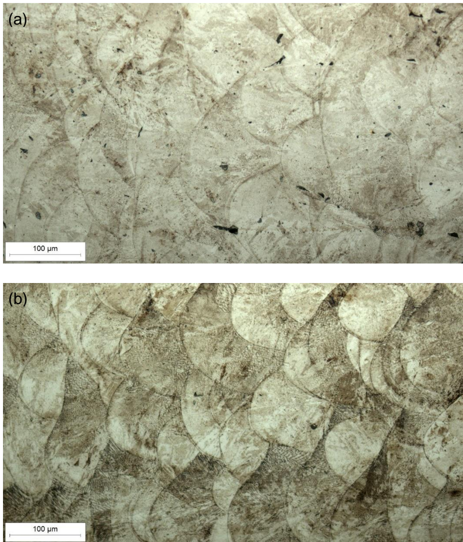
Slika 32. Povećanje 200 x. (a) Poprečni presjek uzoraka u „as built“ stanju s debljinom sloja taljenja od 40 μm. (b) Uzdužni presjek uzoraka u „as built“ stanju s debljinom sloja taljenja od 50 μm.
