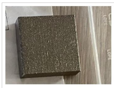
Slika 23. Uzorak MARAGING čelika dobivenog SLM postupkom.
