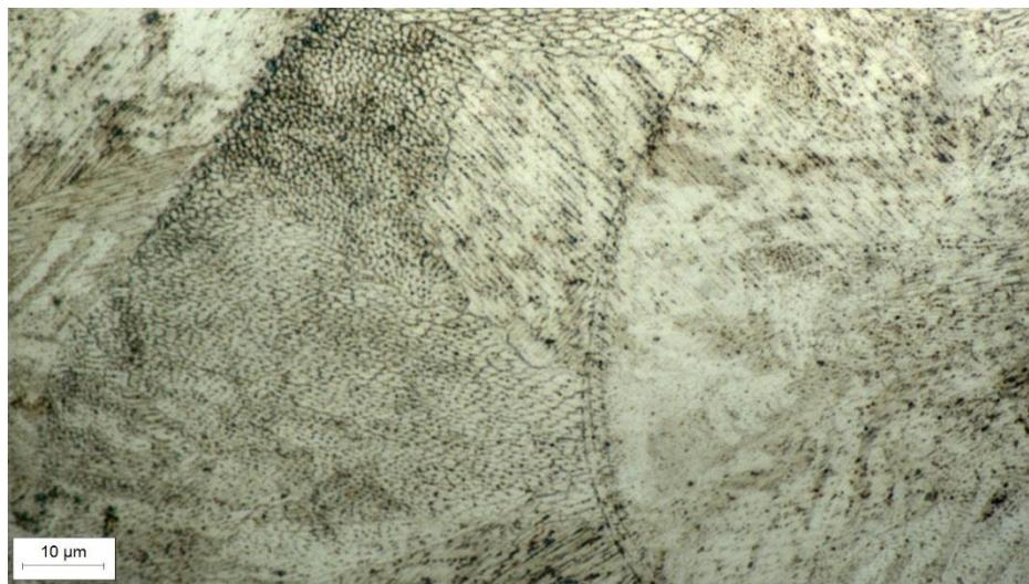
Slika 34. Uzorak u „as built“ stanju povećan 1000 x.
