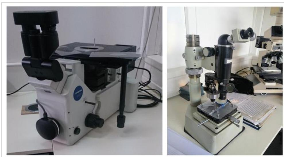
Slika 30. Svjetlosni mikroskop Olympus GX 51 (lijevo) i mikrotvrdomjer PMT3 (desno).
