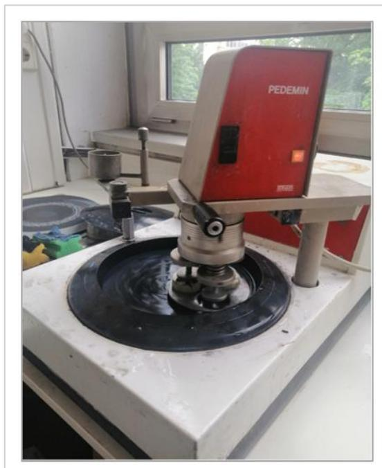
Slika 28. Uređaj za brušenje i poliranje Struers Pedemin.
