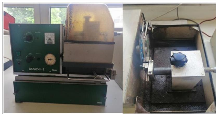
Slika 25. Rezalica Struers Accutom-2.
