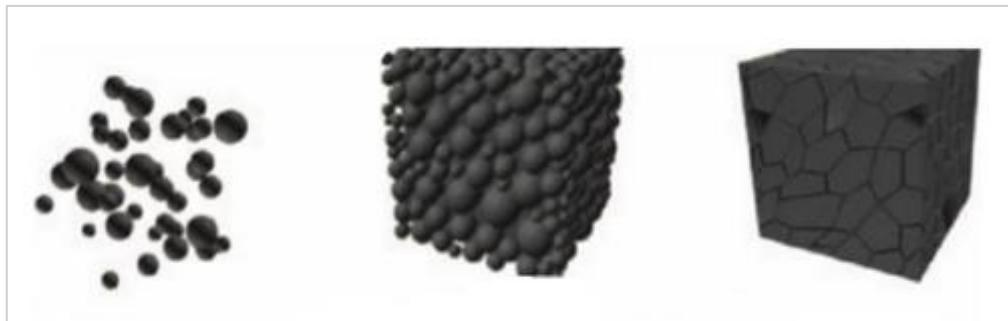
Slika 10. Kompaktiranje i sinteriranje praha. [18]
