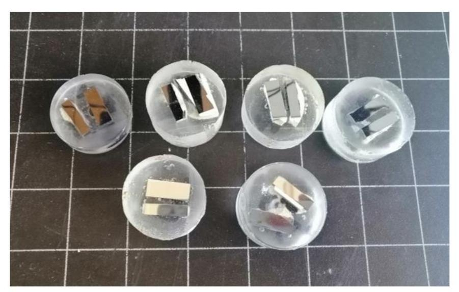
Slika 29. Uzorci nakon metalografske pripreme.
