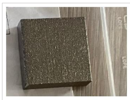
Slika 23. Uzorak MARAGING čelika dobivenog SLM postupkom.
