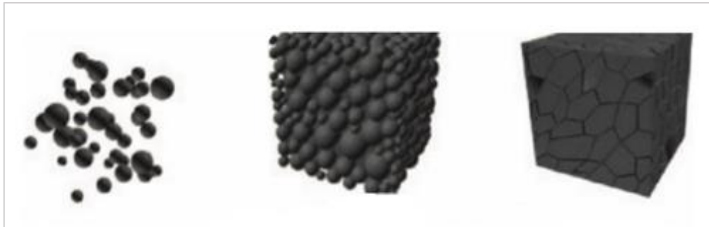
Slika 10. Kompaktiranje i sinteriranje praha. [18]
