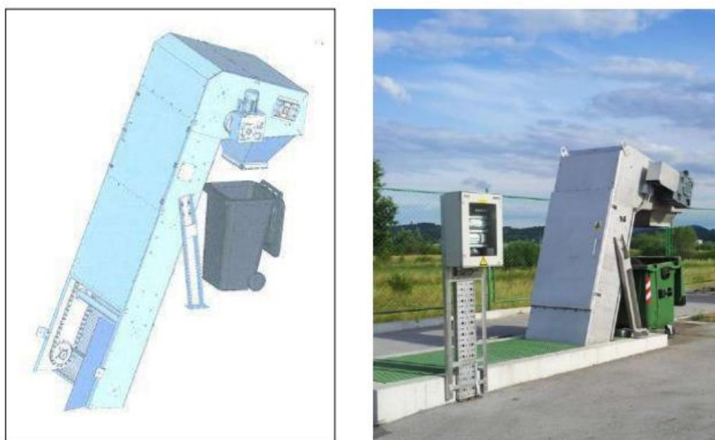
Slika 4.3. Primjer automatske grube rešetke [12]
