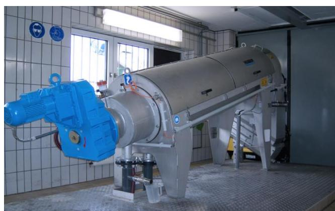
Slika 4.10. Primjer spiralne preše za dehidraciju mulja [14]
