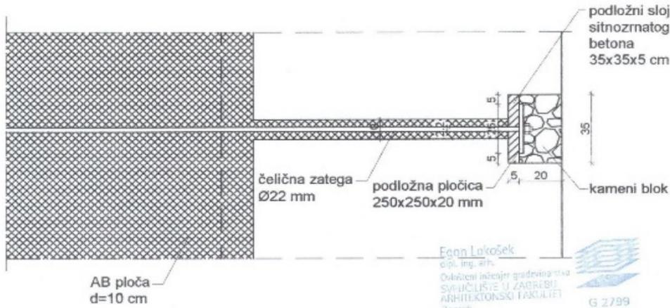
Kroz AB ploču debljine 10 cm prolaze čelične zatege Ø22mm na pozicijama kako je prikazano na tlocrtu. Zatege se sidre na čelične podložne pločice dimenzija 250x250x20 mm koje su postavljene na podložni sloj sitnozrnatog betona debljine 5 cm koji je upušten u zid cca. 20 cm. Svi čelični dijelovi (podložna pločica i matica) zaštićuju se barem 3 cm debelim slojem 'Masterflow 928', a na kraju se sve zatvara kamenim blokom odgovarajućih dimenzija.
