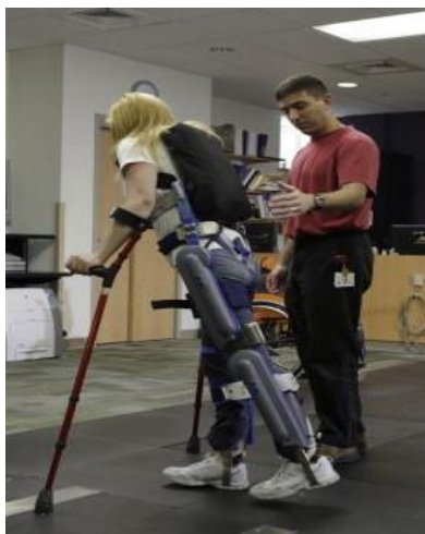
Slika 7.3. Prikaz HKAFO ortoze prilikom hoda sa štakama
