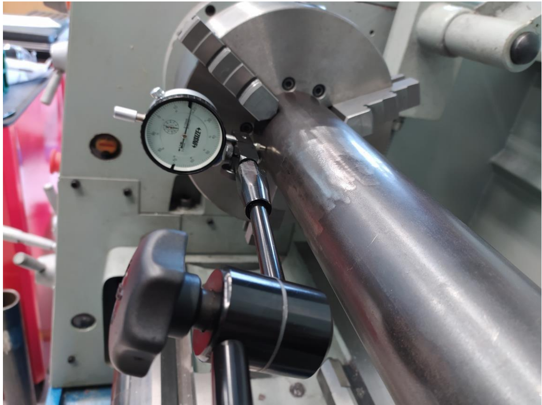
Slika 31. Kružnost cijevi prije predgrijavanja i navarivanja [17]
