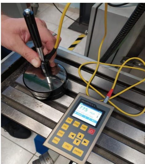
Slika 32. Uređaj za mjerenje tvrdoće i kalibriranje istog. [17]
