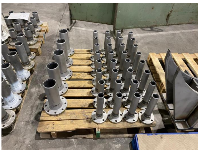
Slika 4-2 Zavarene cijevi i prirubnice
