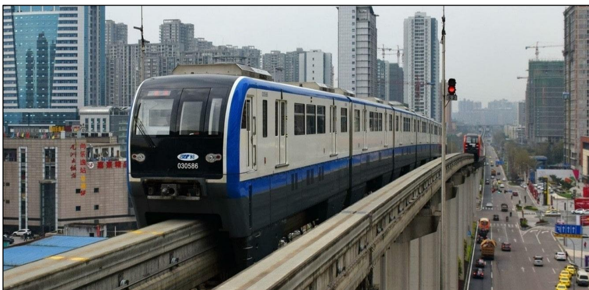
Slika 4.12. Jednokolosiječno željezničko vozilo u NR Kini
