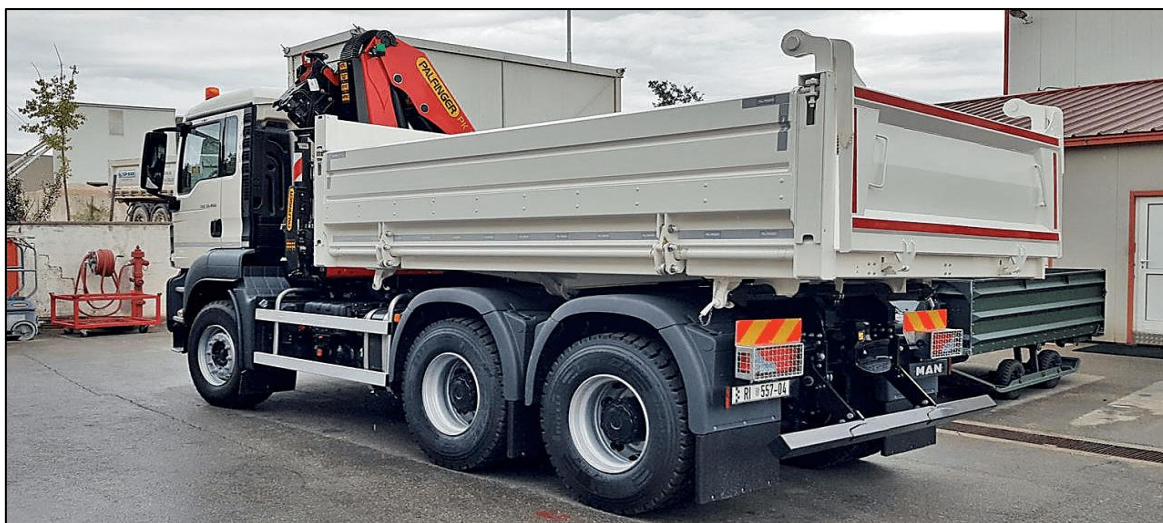
Slika 4.21. Kamion s kranom
