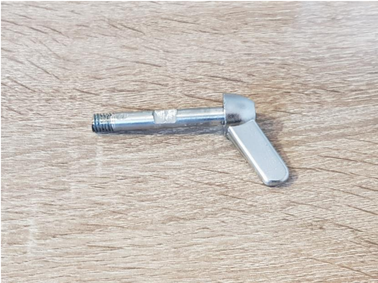
Slika 24. Zakretna poluga sa ručkom
