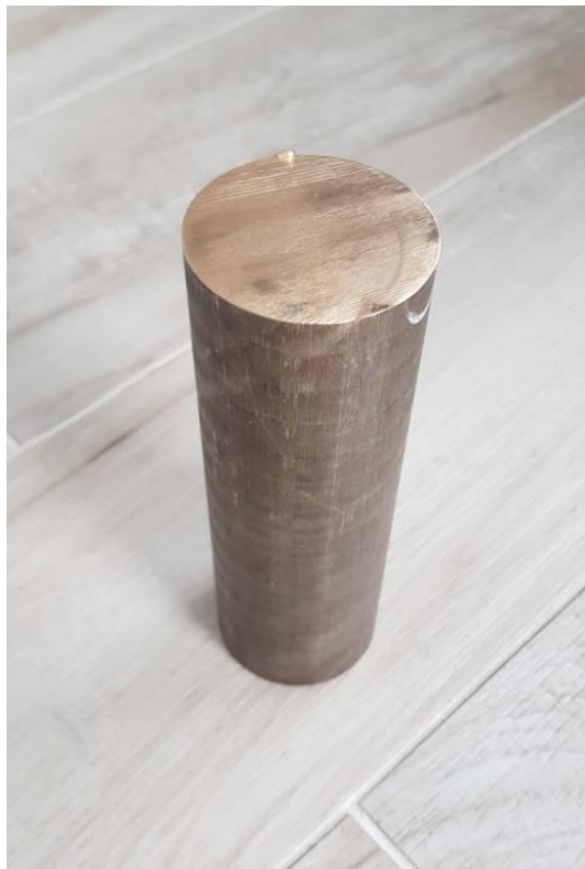
Slika 26. Brončana poluga za izradu utega
