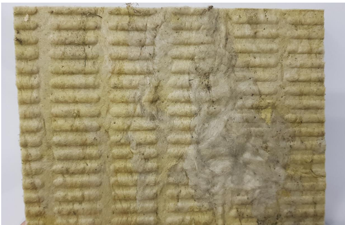
Slika 44. Nepravilnosti u materijalu
