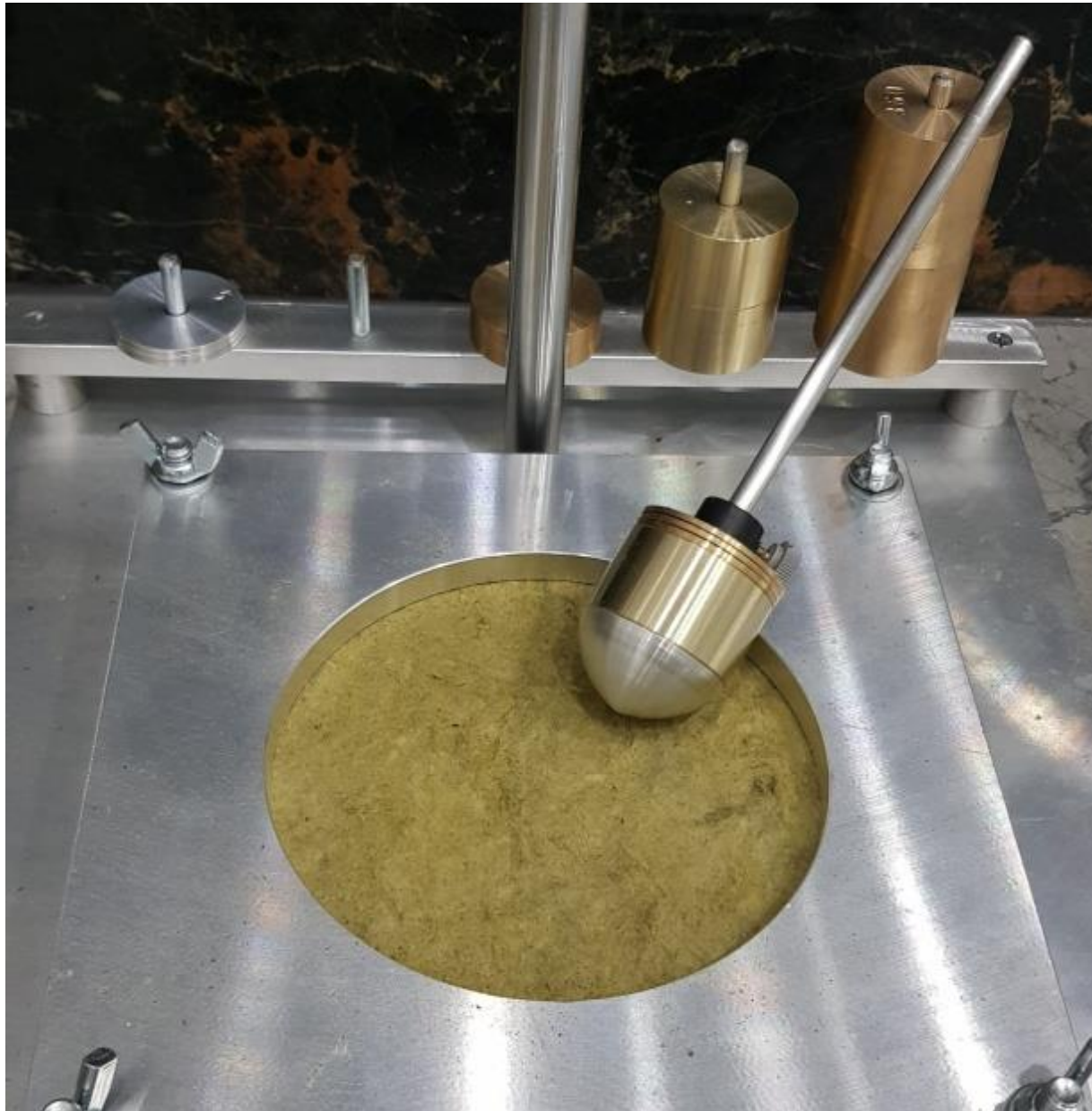
Slika 40. Uteg ne probija uzorak
