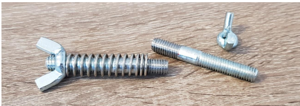
Slika 29. Vijci s oprugama i leptir maticama
