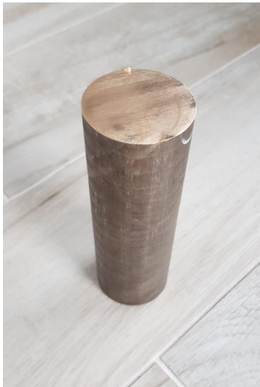
Slika 26. Brončana poluga za izradu utega
