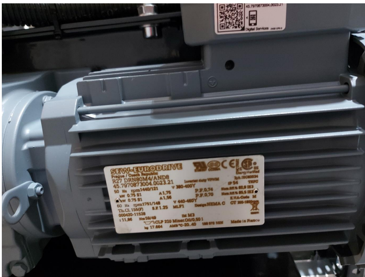
Slika 7.2 Izgled asinkronog motora, te natpisna pločica
