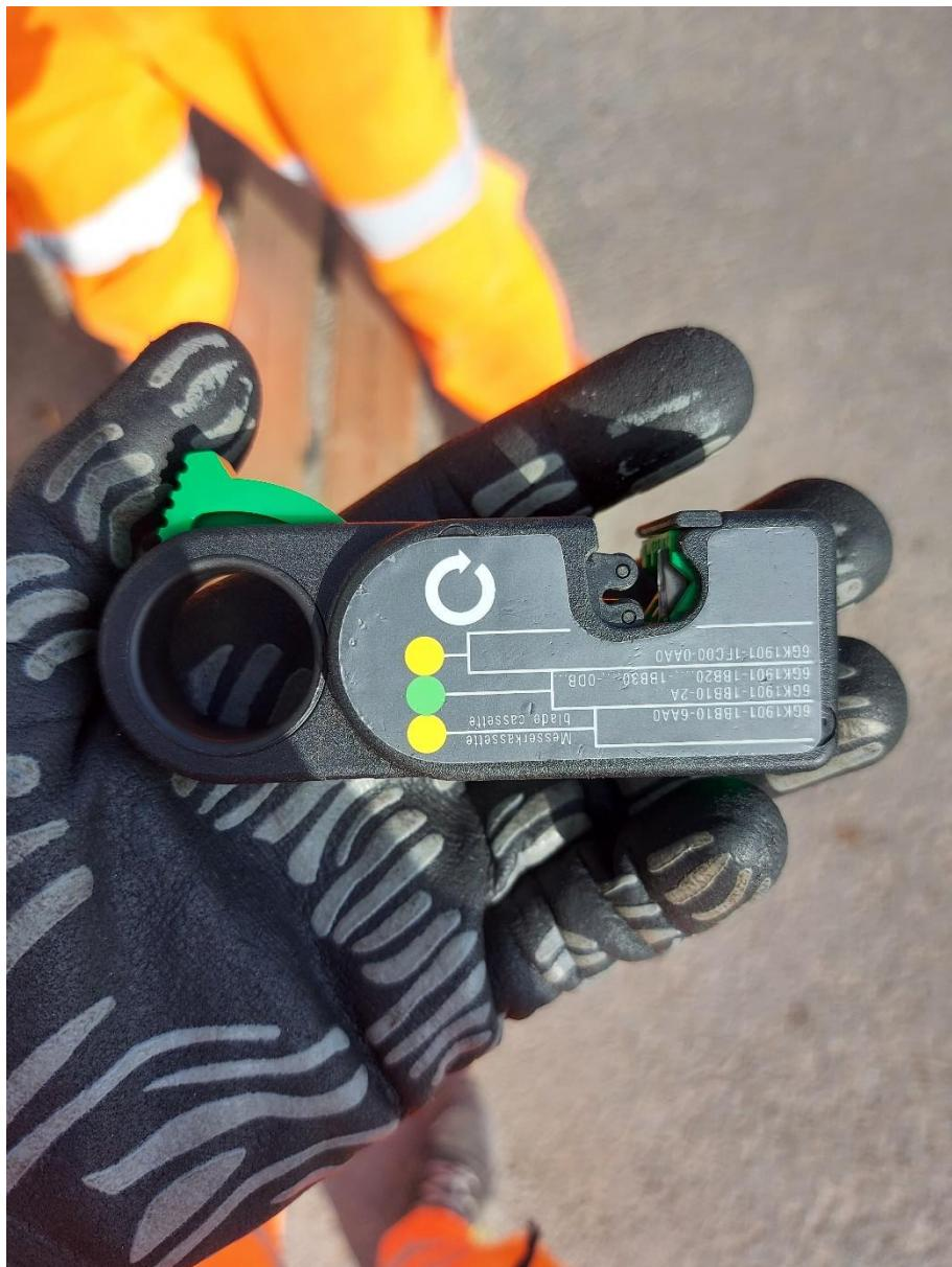
Slika 6.14 Posebni alat za skidanje izolacije profinet kablova
