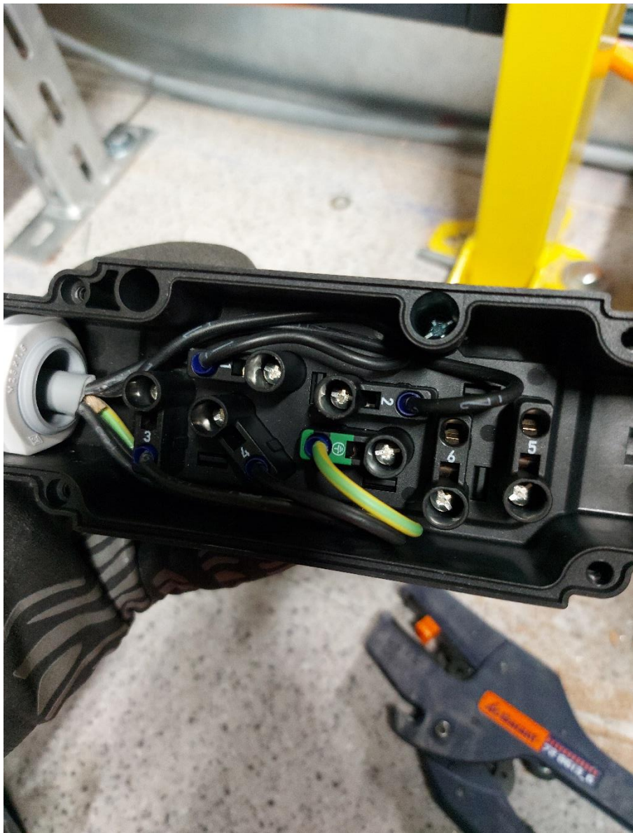
Slika 6.5 Priključni modul sa 5 žica za 400V
