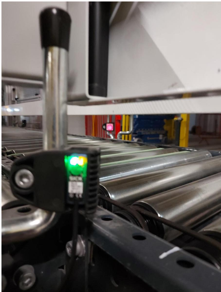
*Slika 9.8 Senzor daje povratni signal sa reflektirajuće trake*
