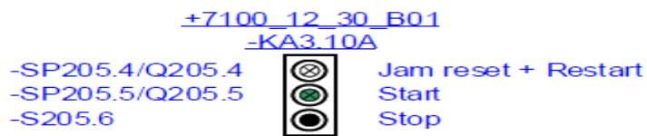
Slika 7.9. Primjer izgleda tipkala na nacrtu [4]
