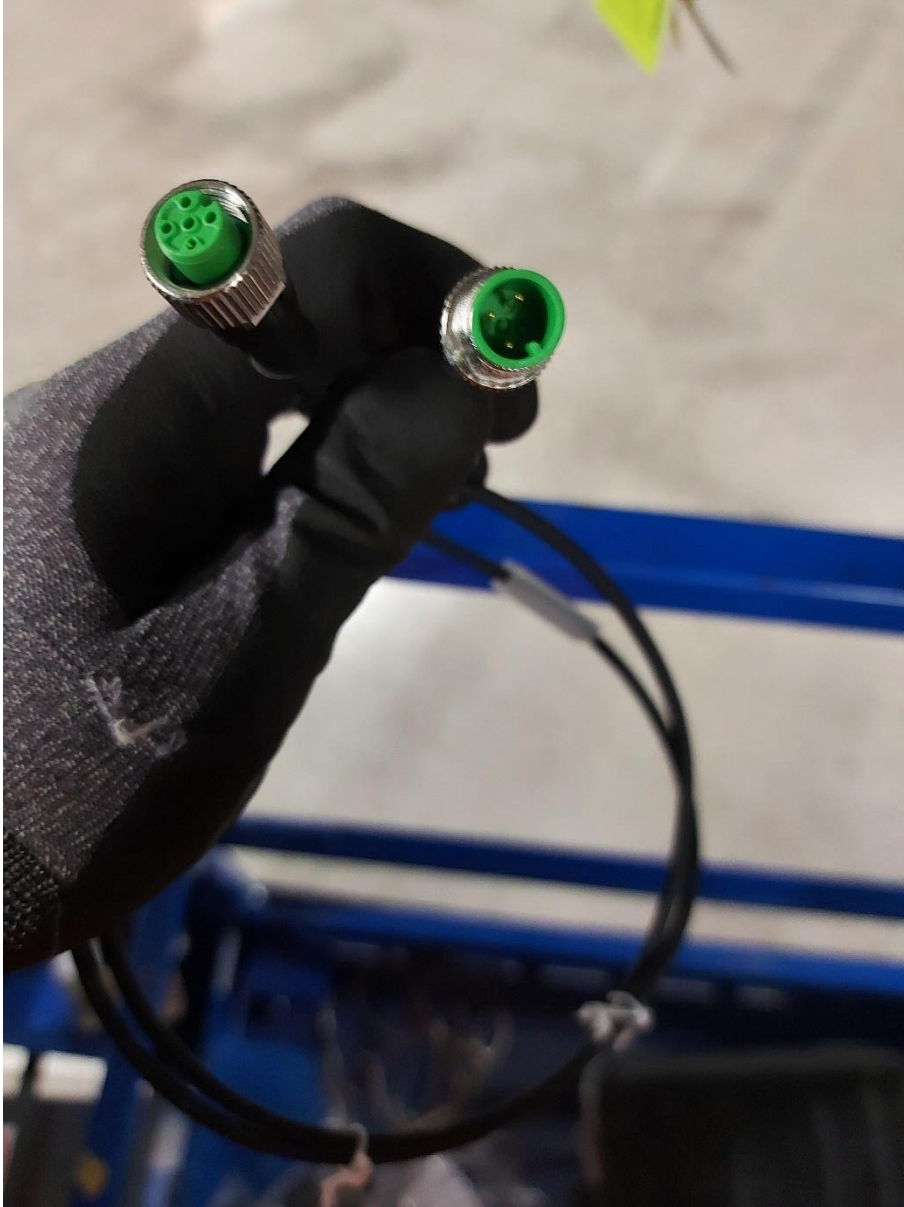
Slika 6.8 M12 muški – M12 ženski kabel
