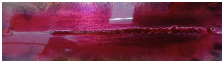
Slika 39. Slike zavara nakon nanošenja penetranta
