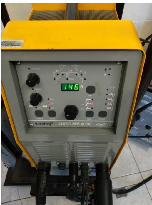
Slika 29. VARTIG 2005 AC/DC uređaj proizvođača Varstroj
