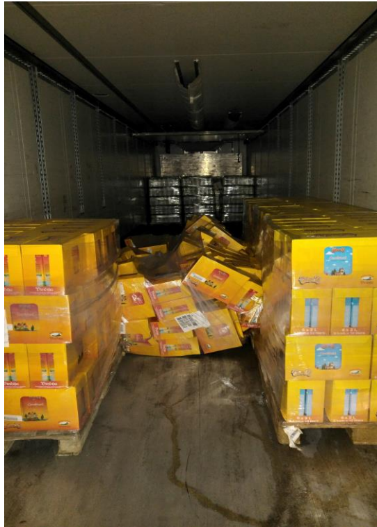
Slika 5 - Primjer neadekvatnog utovarenog prijevoznog sredstva s posljedicama
