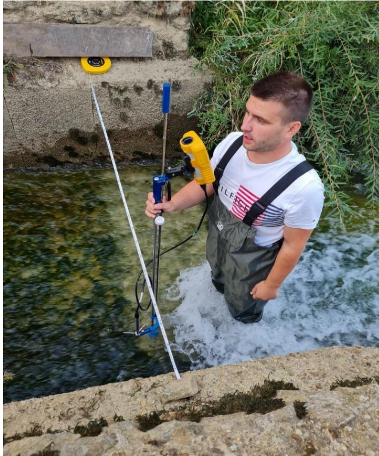
Slika 23. Instrument FlowTracker2 u radu [3]
