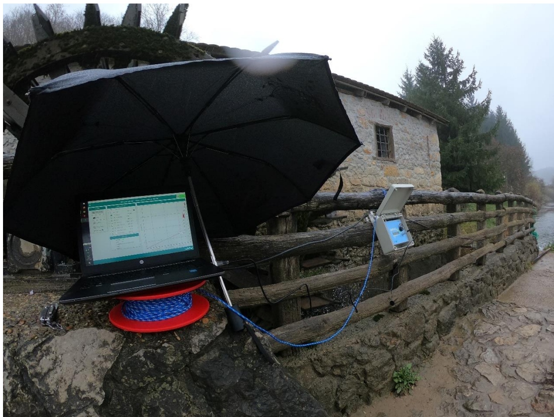
Slika 33. Analiza i obrada podataka SQ-R Flow Meter [3]
