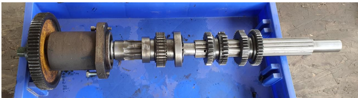
Slika 6.3 Dijelovi stroja na vratilu
