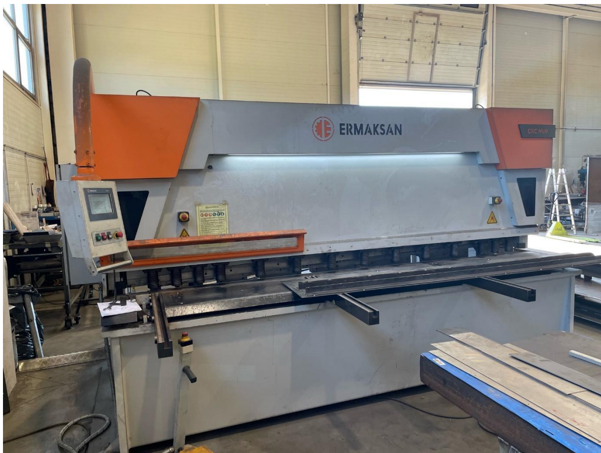
Slika 48. Škare za lim proizvođača Ermaksan
