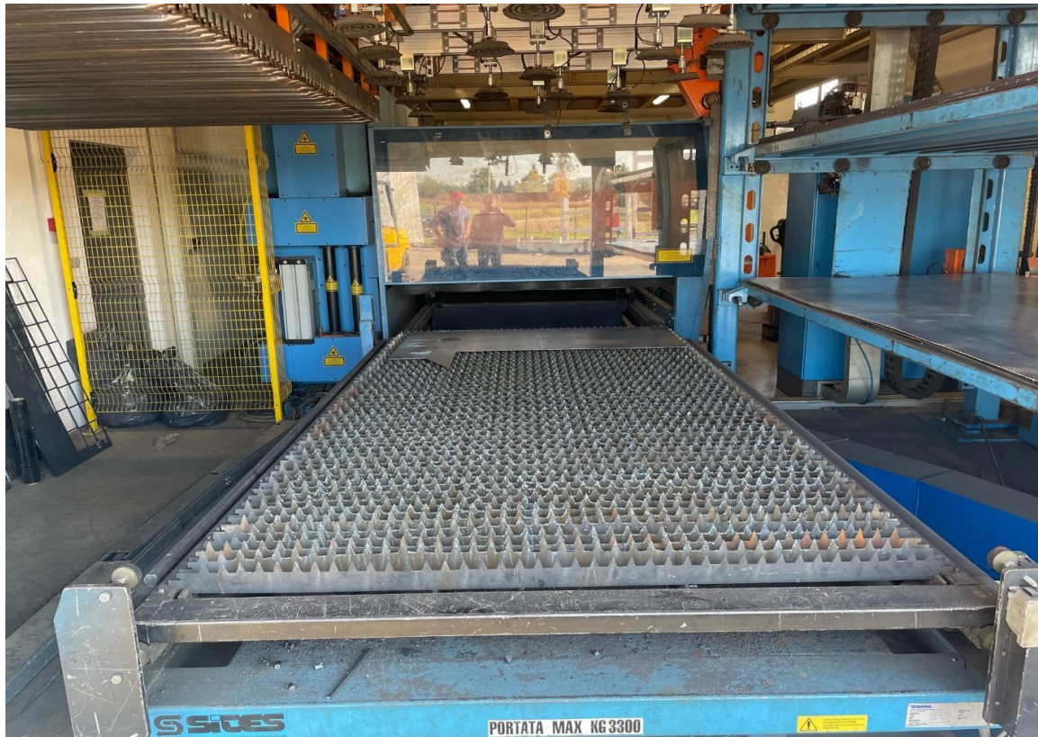
Slika 46. Mjesto za zamjenu komada i provjeru pozicija
