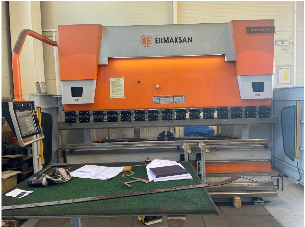
Slika 47. Apkant preša proizvođača Ermaksan
