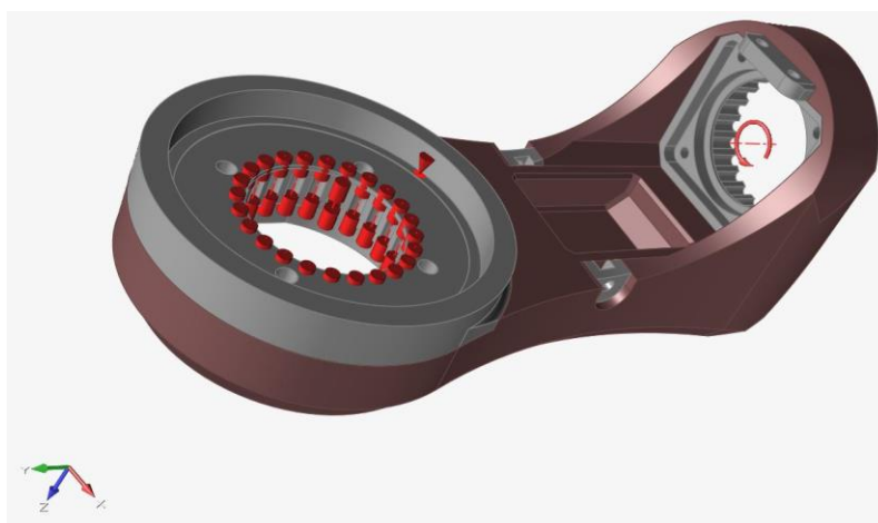
Slika 36. Definirana opterećenja i oslonci za slučaj djelovanja maksimalnog okretnog momenta (iz vlastite arhive: 01.12.2021. 00:16)
