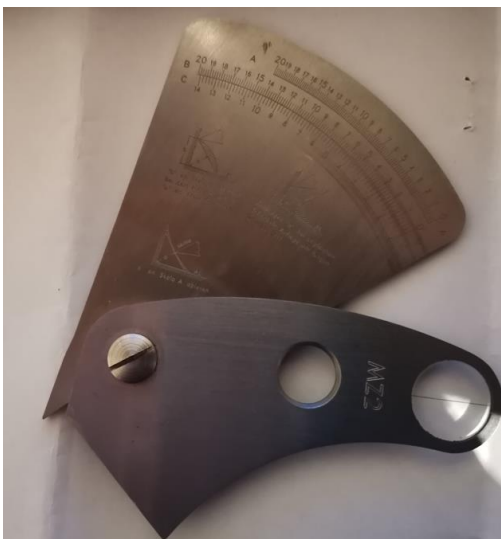
Slika 4.26. Mjerilo sa tri skale
