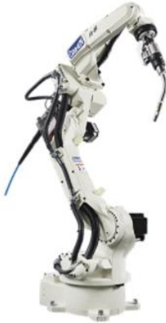
Slika 2.9. OTC robot za zavarivanje [3]
