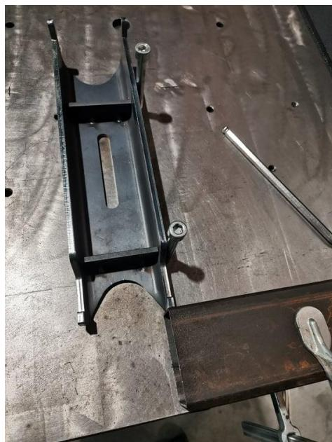
Slika 4.7. Pripremljen radni komad
