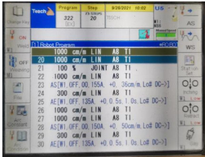
Slika 4.12. Programske komande za zavarivanje druge pločice
