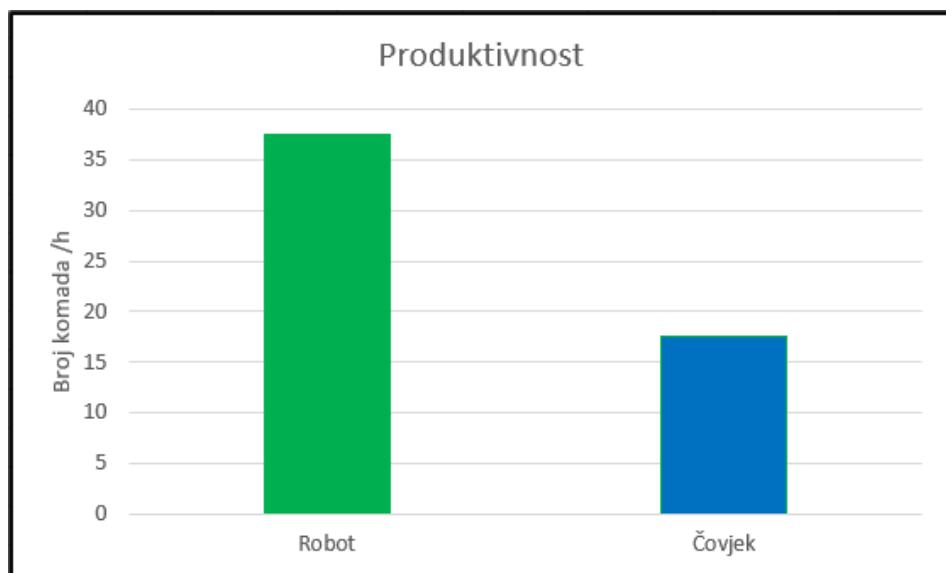
Slika 4.29. Produktivnost robota i čovjeka u 1 satu
