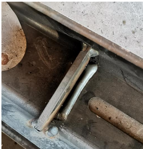
Slika 4.20. Nepravilno pripajanje pločice
