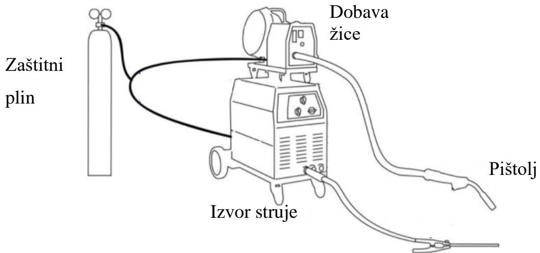
Slika 3.1. Shematski prikaz aparata za MAG zavarivanje [11]
