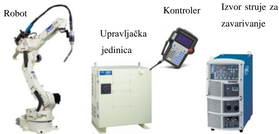
Slika 2.8. Osnovni sustav za robotizirano zavarivanje
