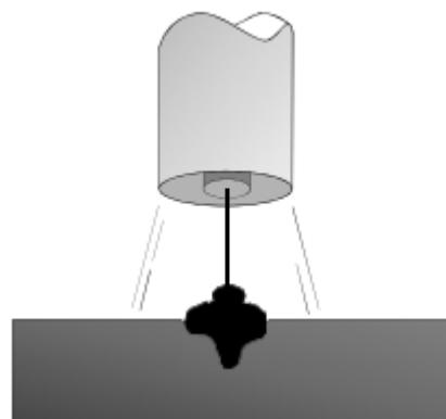
Slika 3.2. Prijelaz metala kratkim spojevima [4]
