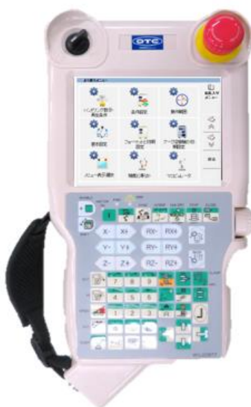
Slika 2.10. Kontroler tvrtke OTC [5]
