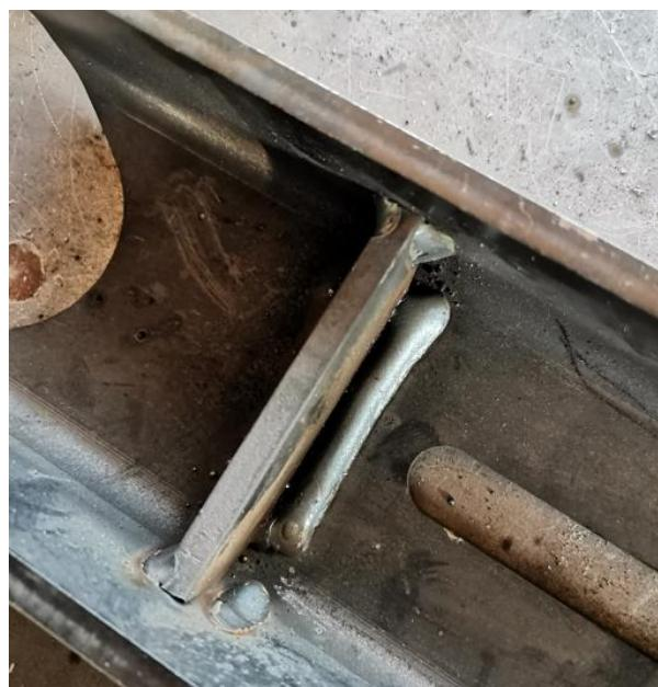
*Slika 4.20. Nepravilno pripajanje pločice*
