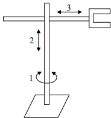
*Slika 2.5. Cilindrična RTT struktura [2]*
