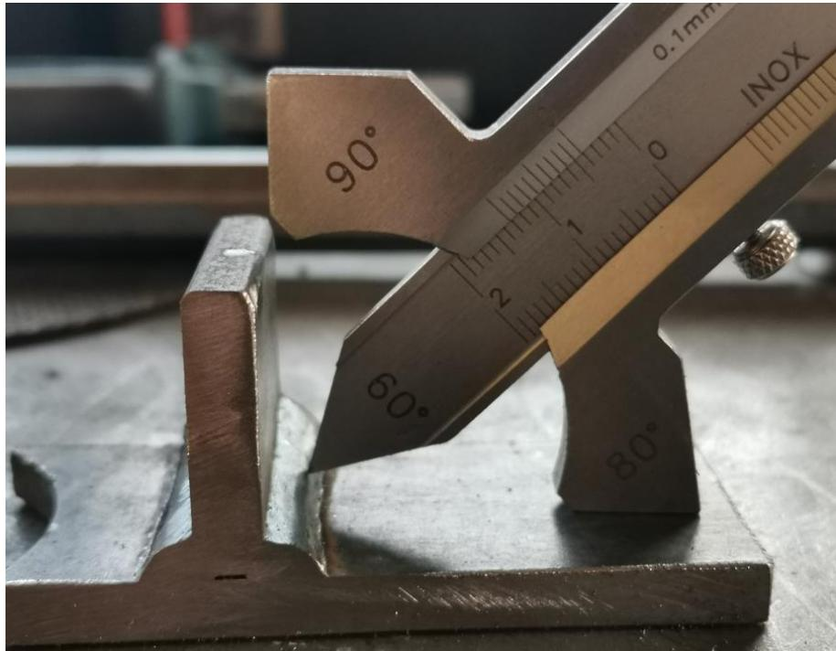
Slika 4.25. Mjerenje debljine zavara
