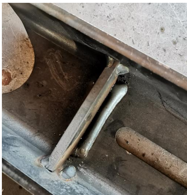
Slika 4.20. Nepravilno pripajanje pločice
