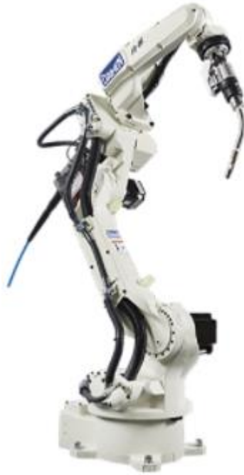
Slika 2.9. OTC robot za zavarivanje [3]
