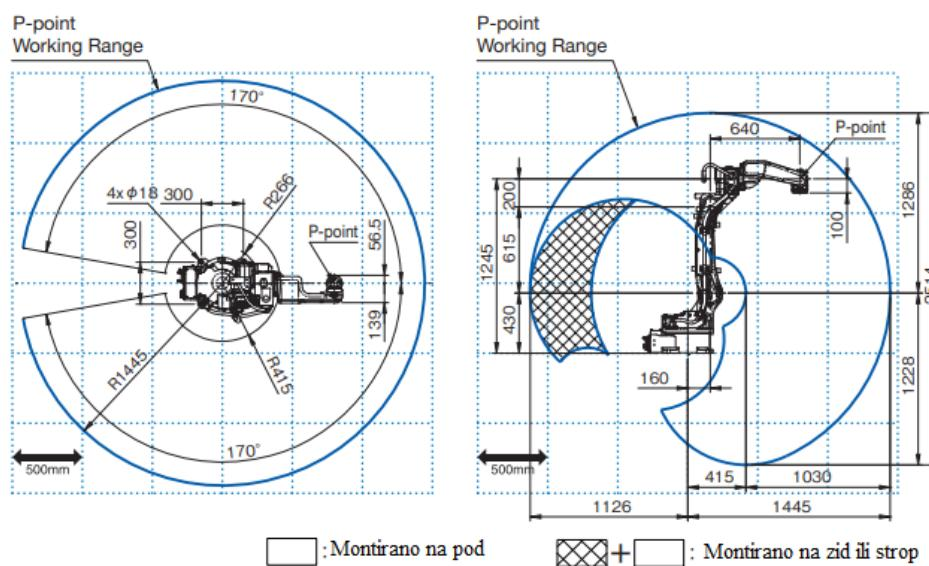
*Slika 4.2. Radni prostor robota FD-B6 [14]*
