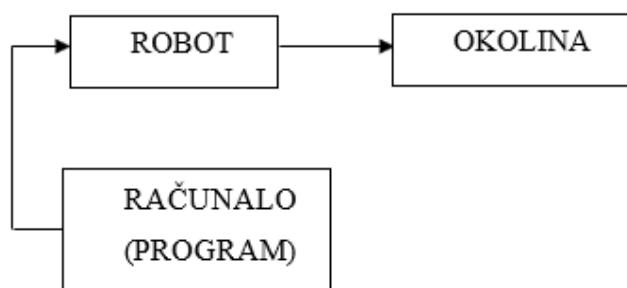
*Slika 2.1 Shema prve generacije robota*
