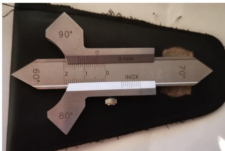
Slika 4.24. Mjerilo za debljinu zavara
