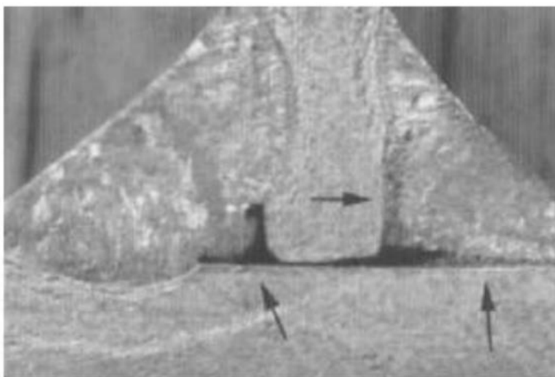
Slika 3.10. Naljepljivanje u kutnom spoju [29]
