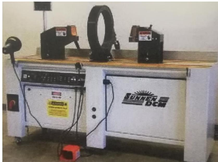
Slika 2.14. Stacionarni stoj za magnetiziranje [17]
