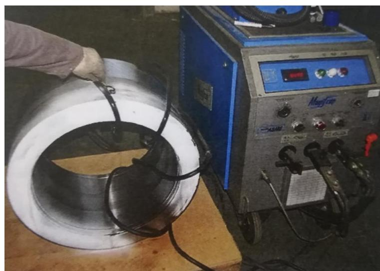
Slika 2.9. Ispitivanje zavojnicom [17]
