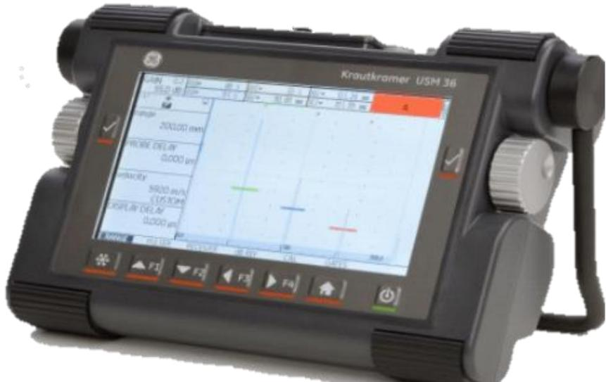
Slika 2.23. Ultrazvučni uređaj Krautkramer USM 36 [22]
