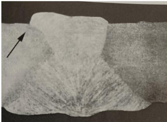
Slika 3.13. Pogreške oblika zavora – oštar prijelaz i preklap [29]
