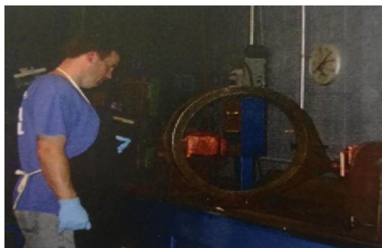
Slika 2.10. Ispitivanje na stroju za magnetizaciju [17]
