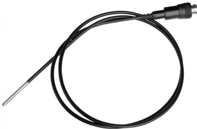
Slika 2.4. Fleksibilni endoskop (fibroskop) [13]
