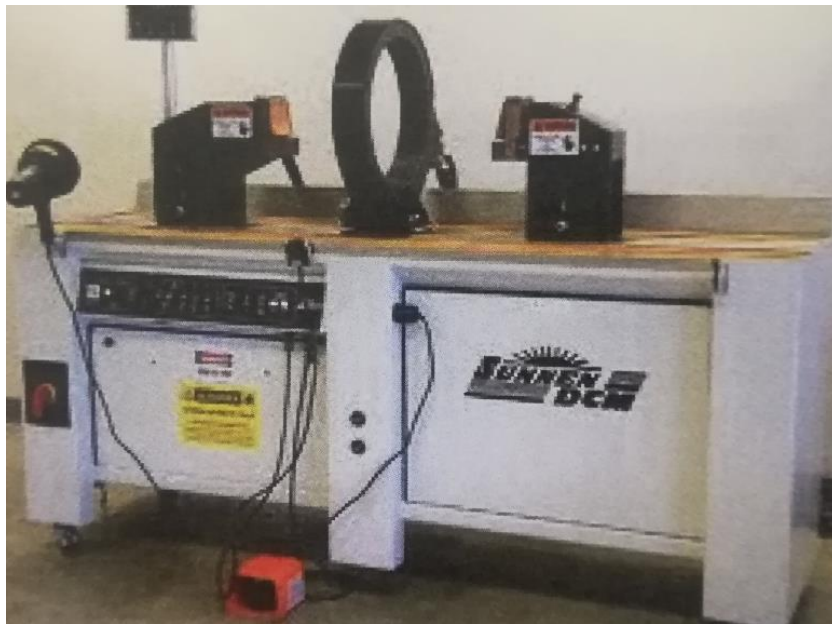
Slika 2.14. Stacionarni stoj za magnetiziranje [17]
