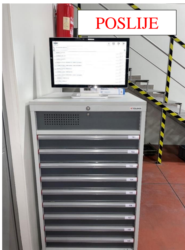
Slika 4. 13 Digitalizirani ormar sa alatom
