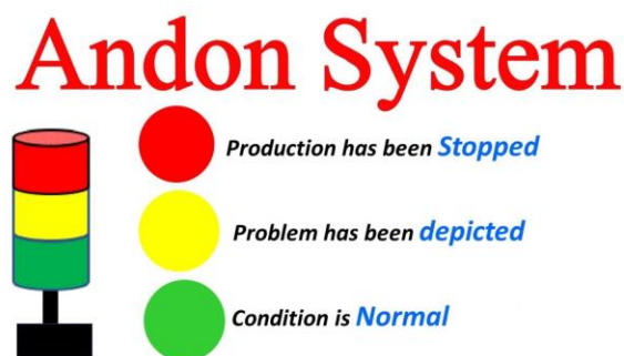
Slika 2. 16 Signalizacija u Andon metodi [11]
