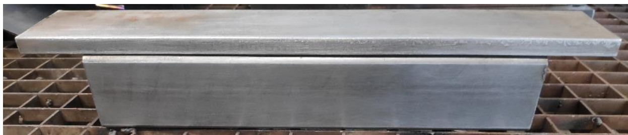
Slika 6.1 Ispitni uzorci nehrđajućeg čelika X5CrNi18–10
