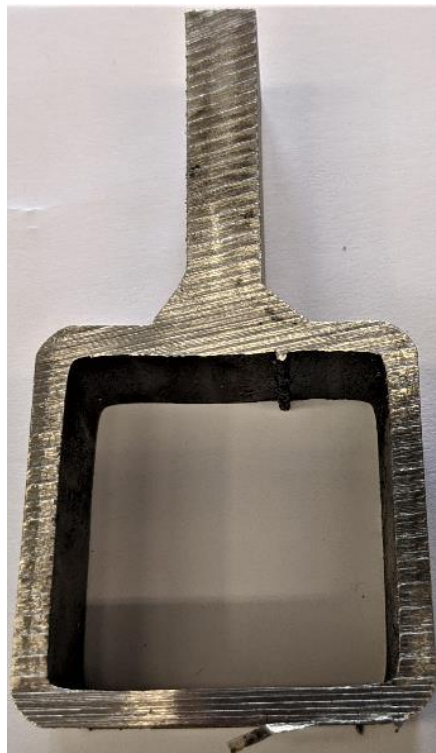
Slika 6.14 Izrezani ispitni uzorak
