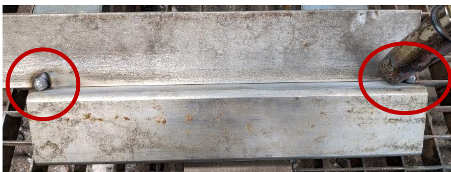
Slika 6.7 Osnovni materijal pripojen u PA položaju
