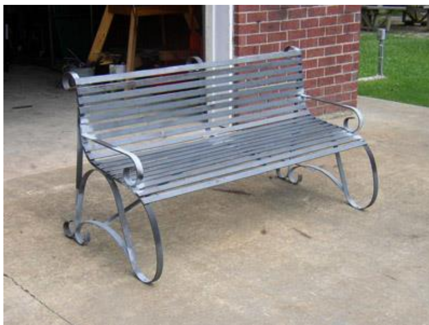
Slika 3.11 Klupa od nehrđajućeg čelika završena MIG postupkom [13]
