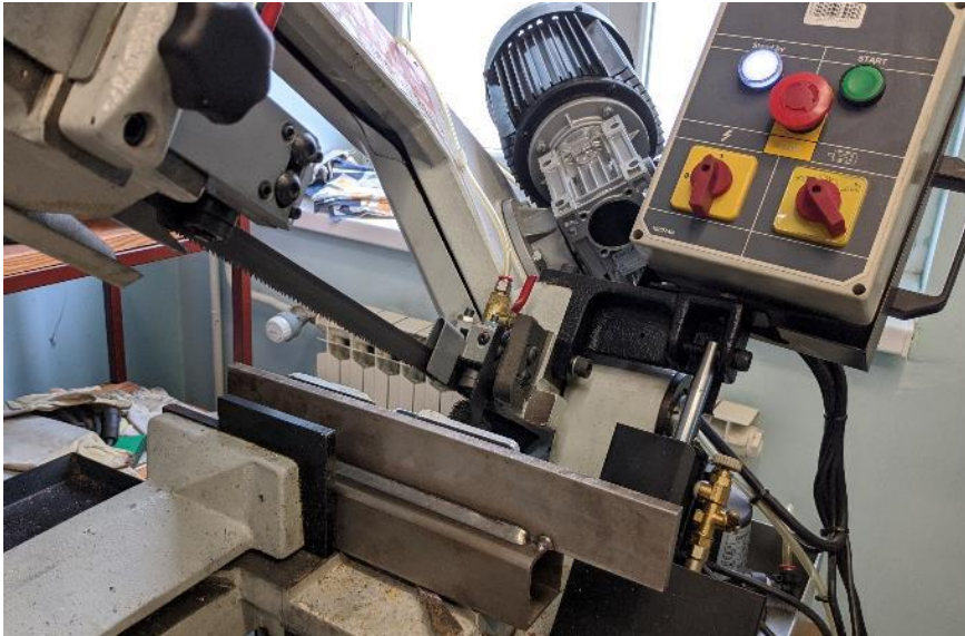
Slika 6.13 Rezanje obratka tračnom pilom
