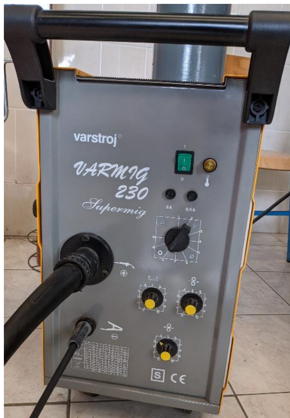
Slika 6.3 Varmig 230 Supermig izvor struje za zavarivanje
