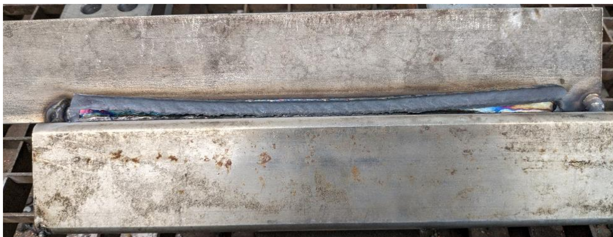
Slika 6.9 Odvojena troska nakon prvog zavara
