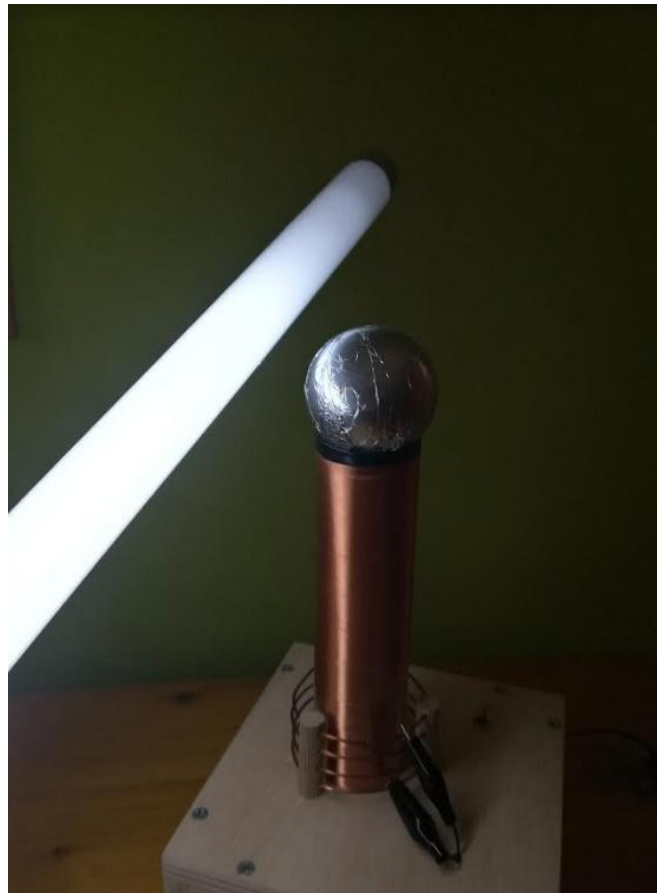
Slika 3.14. Širenje energije Teslinog transformatora
