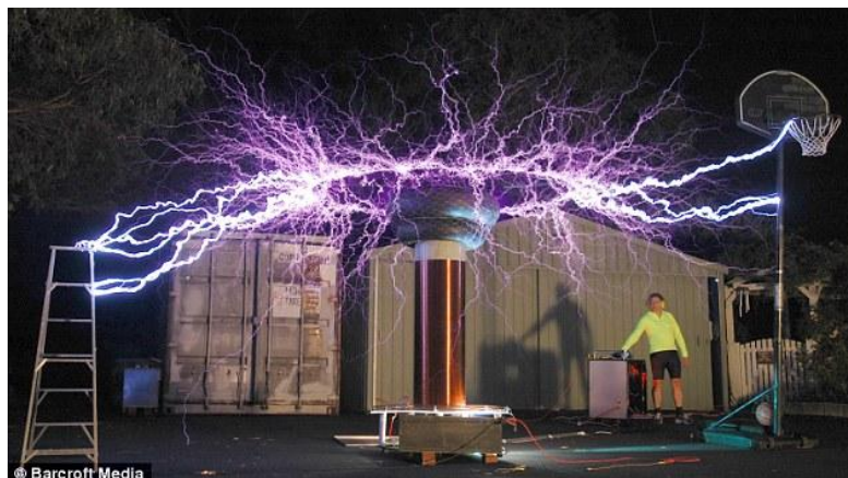
Slika 3.4. VF Teslin transformator
