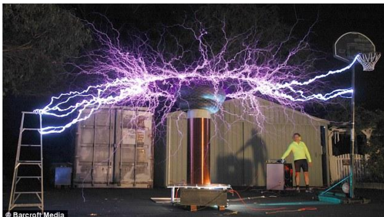
Slika 3.4. VF Teslin transformator
