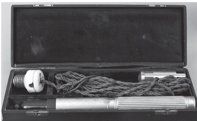
Slika 3.2. Teslin uređaj za liječenje visokofrekventnom strujom s početka 20.stoljeća
