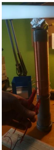
Slika 3.12. Probni rad pobuđivača napona na eksperimentalnoj pločici
