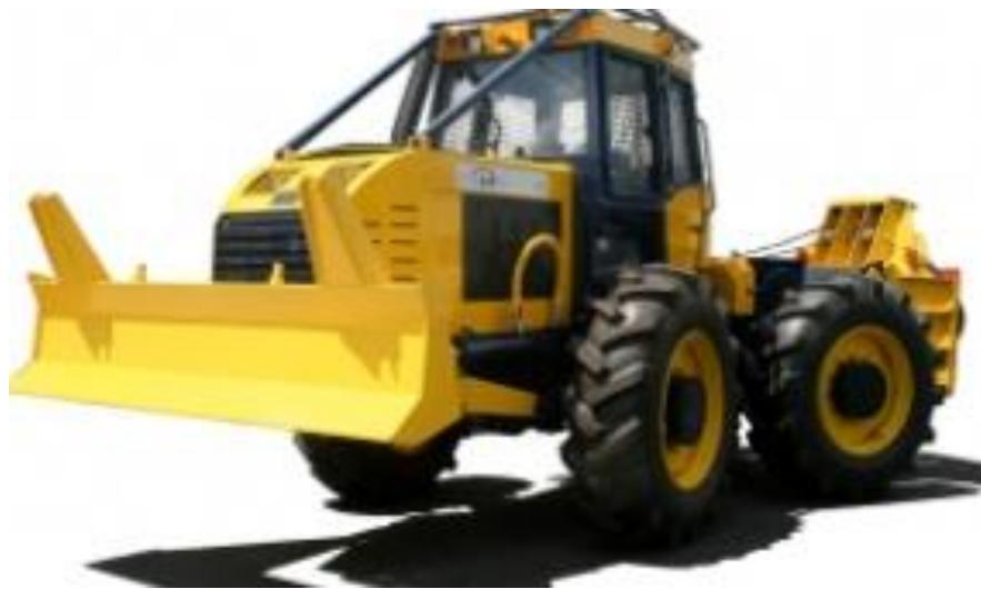
*Slika 1 Šumski zglobni traktor EcoTrac 140 V [2]*
