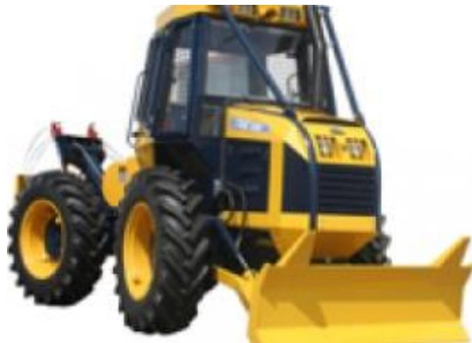
*Slika 3 Šumski zglobni traktor EcoTrac 55 V [2]*
