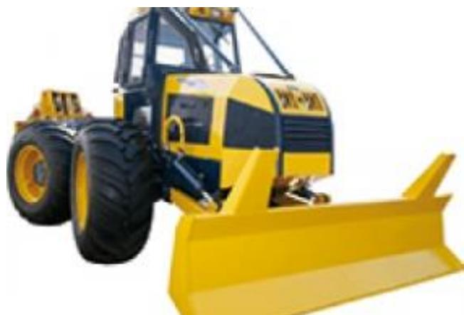
*Slika 2 Šumski zglobni traktor EcoTrac 120 V [2]*
