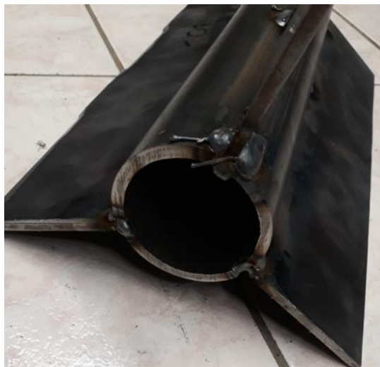
Slika 4.4 Pripremljeni spoj za automatizirano MAG zavarivanje, slikano u laboratoriju Sveučilišta Sjever u Varaždinu 07.04.2022.
