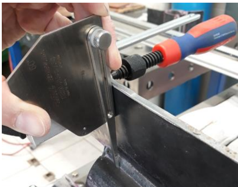
Slika 4.9 Mjerenje visine zavora, slikano u laboratoriju Sveučilišta Sjever u Varaždinu 14.04.2022.
