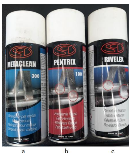
Slika 4.5 Sredstva za provođenje ispitivanja zavara penetrantom ( a- sredstvo za čišćenje metala, b- penetrant crvene boje, c- razvijlač bijele boje), slikano u laboratoriju Sveučilišta Sjever u Varaždinu 08.04.2022.
