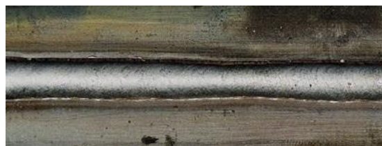
Slika 2.6 Premala brzina zavarivanja [15]
