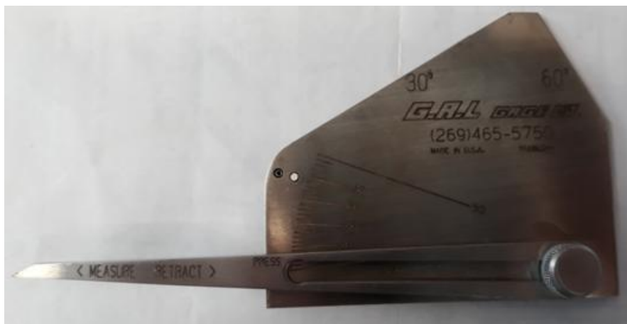
Slika 4.8 Mjerilo za mjerenje visine zavora, slikano u laboratoriju Sveučilišta Sjever u Varaždinu 14.04.2022.
