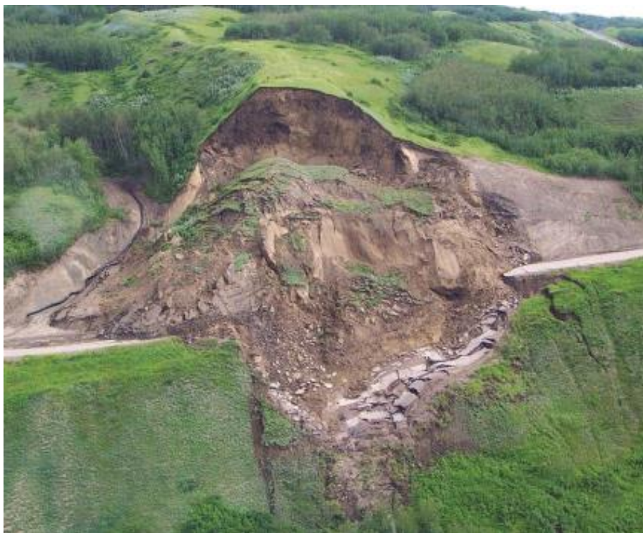
Slika 2.7.: Translacijsko klizanje aktivirano 2001. u Beaton River Valley, British Columbia, Canada [4]
