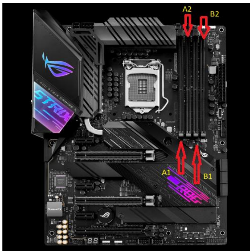
Slika 4.6 Prikaz označenih slotova za RAM [33]
