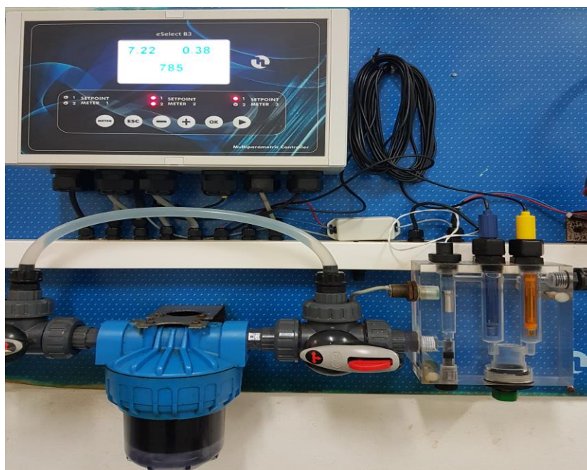
Slika 4.1 Sustav za automatsko mjerenje i regulaciju parametara vode s trenutim vrijednostima na zaslonu mikroprocesora (vlastiti izvor)
