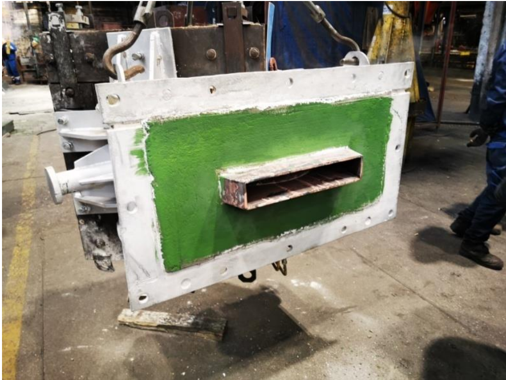
Slika 5.9 Premaz na induktoru [8]
