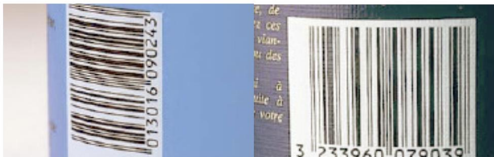
Slika 4-1 Primjer barkoda sa smanjenim ili nepostojećim svijetlim marginama
