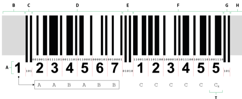
Slika 3-2 Prikaz elemenata EAN-13 crtičnog kôda
