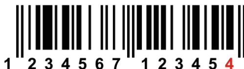
Slika 3-3 Primjer EAN-13 simbologije s pogrešnom kontrolnom znamenkom
