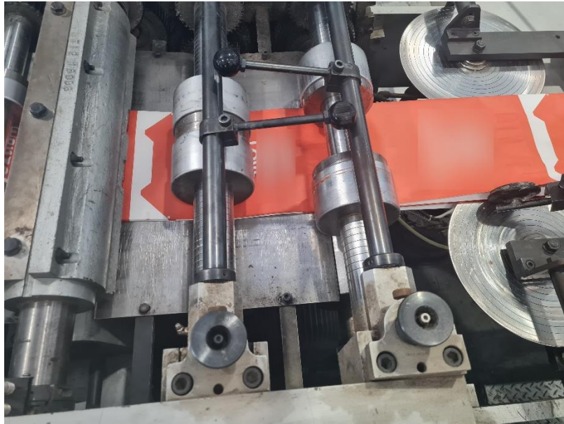
Slika 9.8. Sljepljivanje gornjeg dijela vrećice sa donjim pomoću longitudinalnog ljepila na vučnim valjcima prije rezanja tijela
