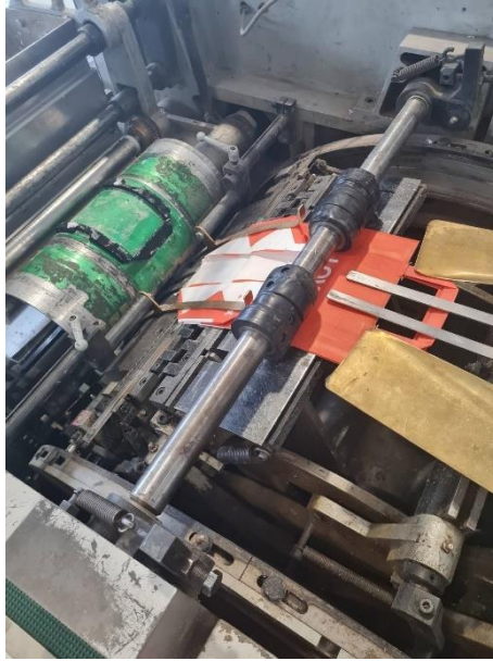
Slika 9.13. Zaglađivanje dna vrećice pomoću dodatnih mesinganih plata „skija“ te lijepljenje dna pomoću klišeja.
