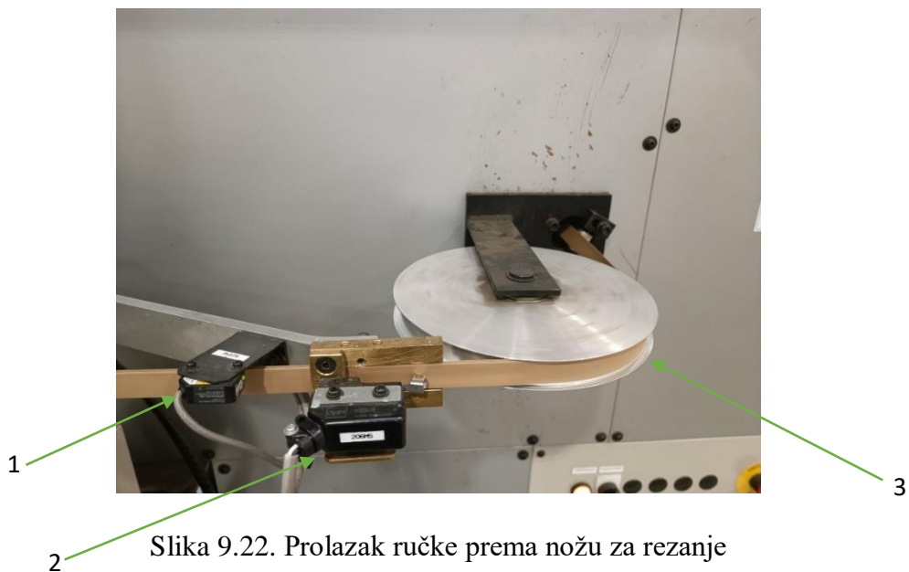
Slika 9.22. Prolazak ručke prema nožu za rezanje (1 – senzor za javljanje anomalije; 2 – senzor za javljanje postojanja pucanja ručke; 3 – aluminijska vodilica)
