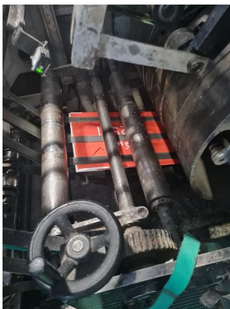
Slika 9.16. Prolazak gotove formirane vrećice remenima na prihvatni bubanj.
