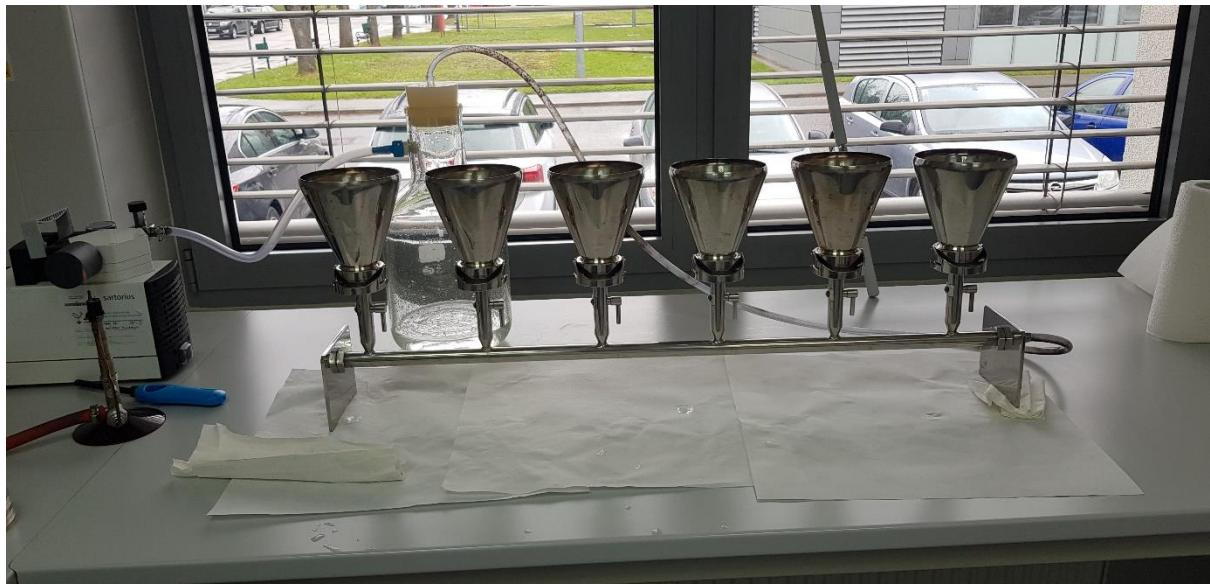
Slika 4.3. Uređaj za membransku filtraciju
