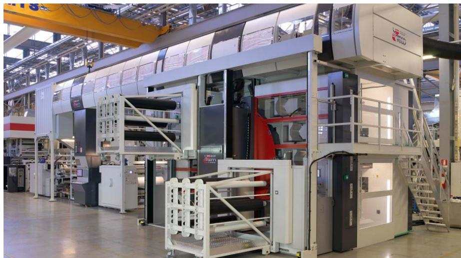
Slika 2.10 Diamond HP s 10 tiskovnih jedinica proizvođača Ut eco
