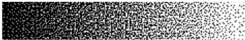
Slika 7.3 Frekventno modulirani (FM) raster
