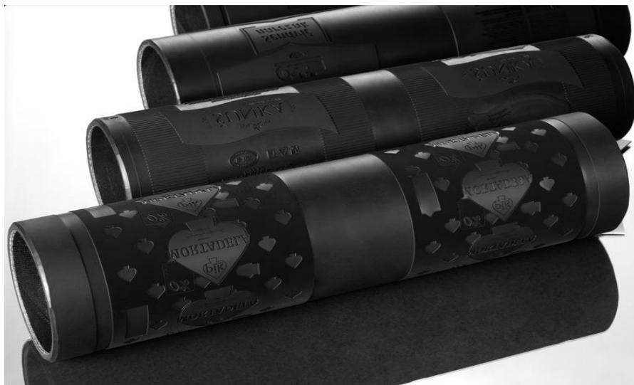
Slika 5.4 Gumena tiskarska ploča montirana na temeljni cilindar
