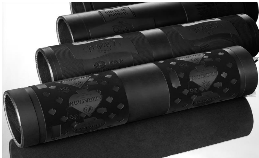
Slika 5.4 Gumena tiskarska ploča montirana na temeljni cilindar
